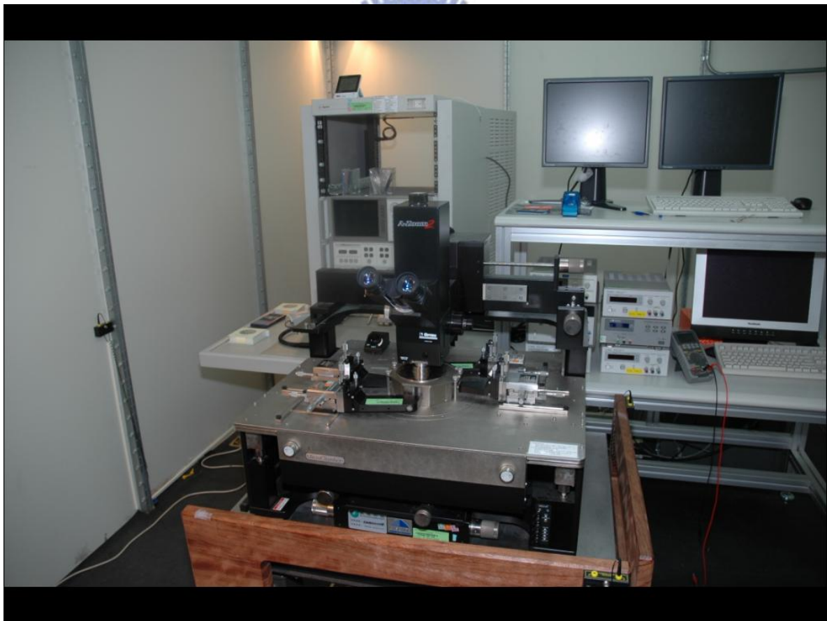
圖 A-6 8510C 高頻網路分析儀的量測環境
