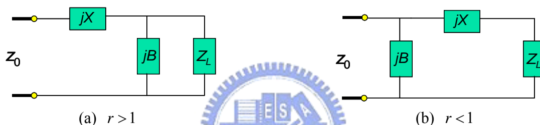
圖 3.5 L 型匹配網路設計
