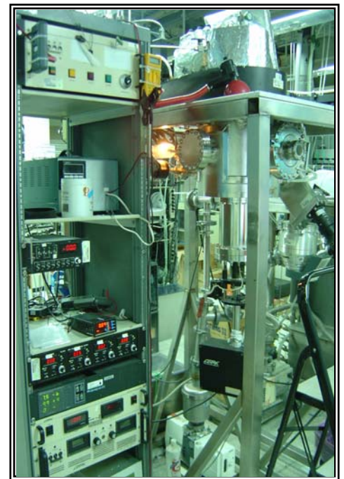
圖4.2 電子迴旋共振微波電漿化學氣相沈積系統 (a) 系統結構示意圖 (b) 實體圖 (台大凝態研究中心-尖端材料實驗室)
