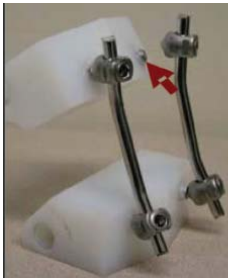
圖 3-10 椎足螺釘系統斷裂處[51]
