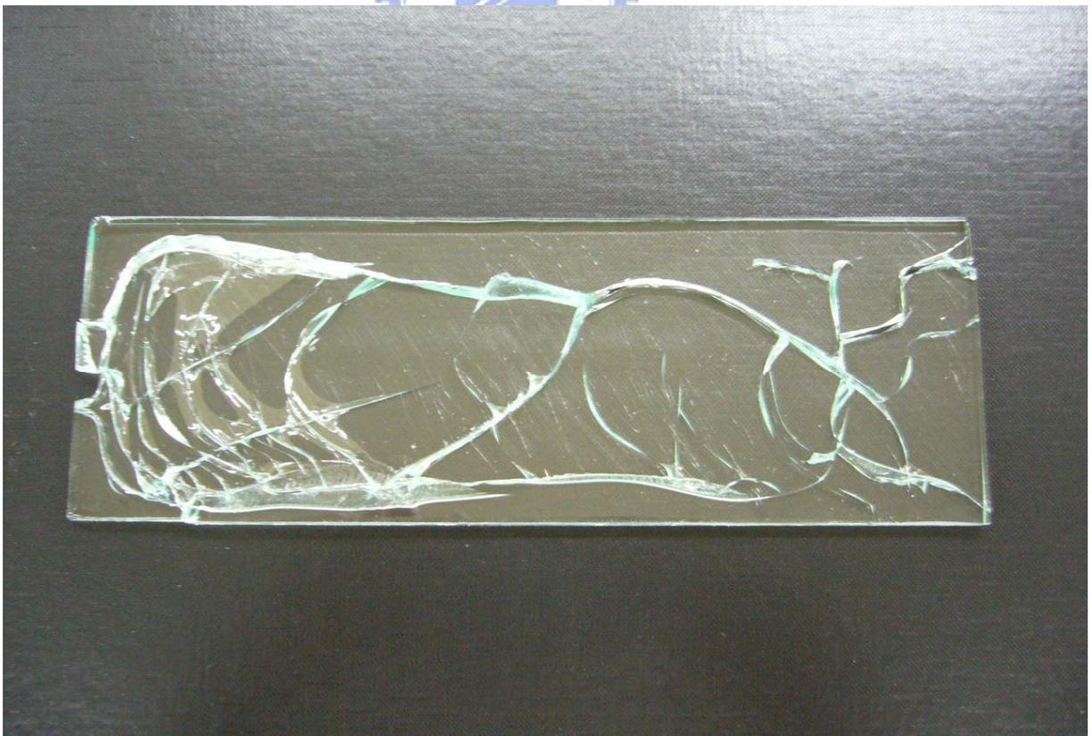
圖 5-12 Under - heated 的玻璃試片
