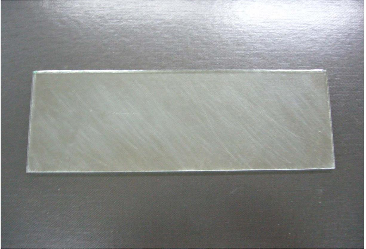
圖 5-5 火焰拋光前的玻璃試片
