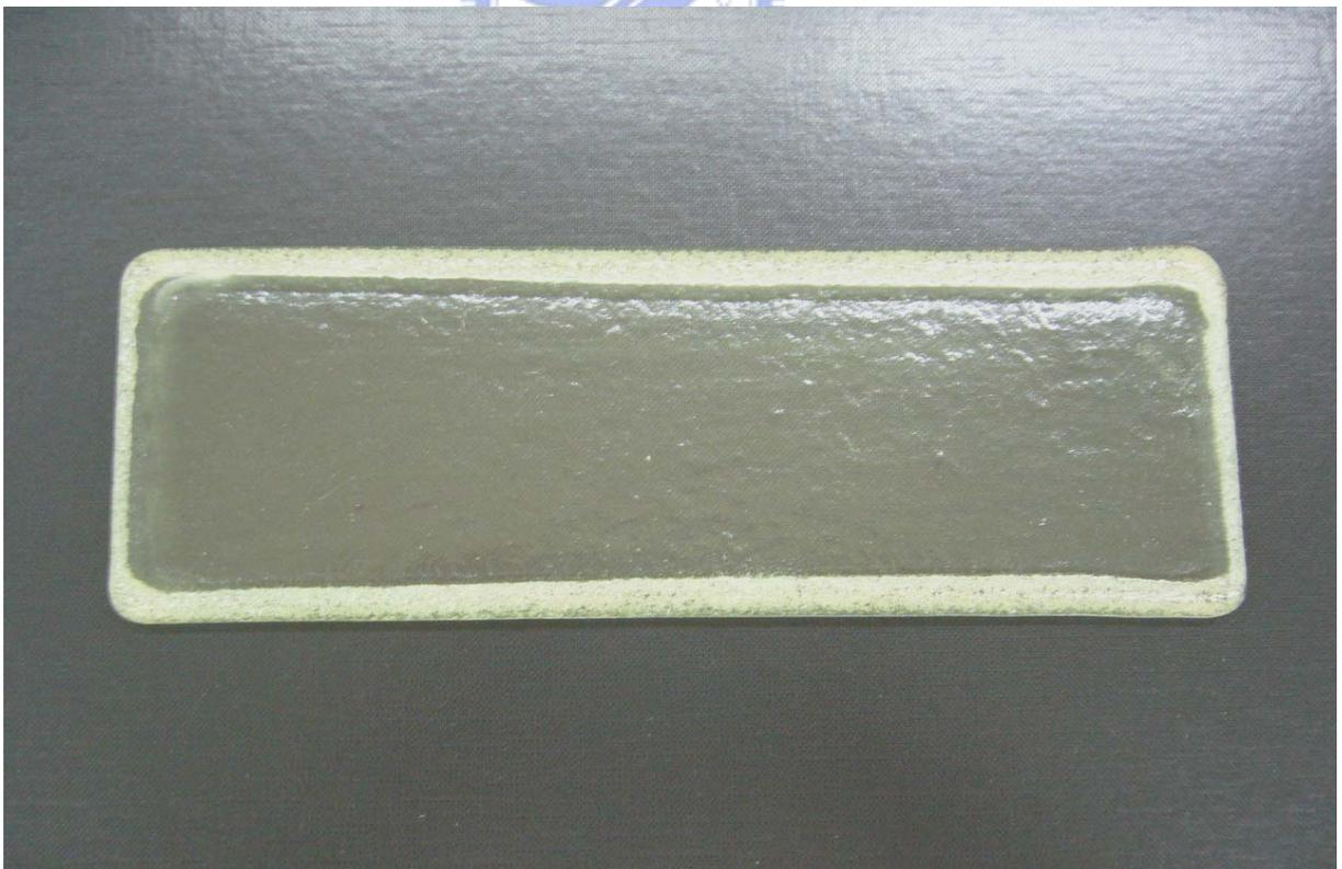
圖 5-10 Over - heated 的玻璃試片
