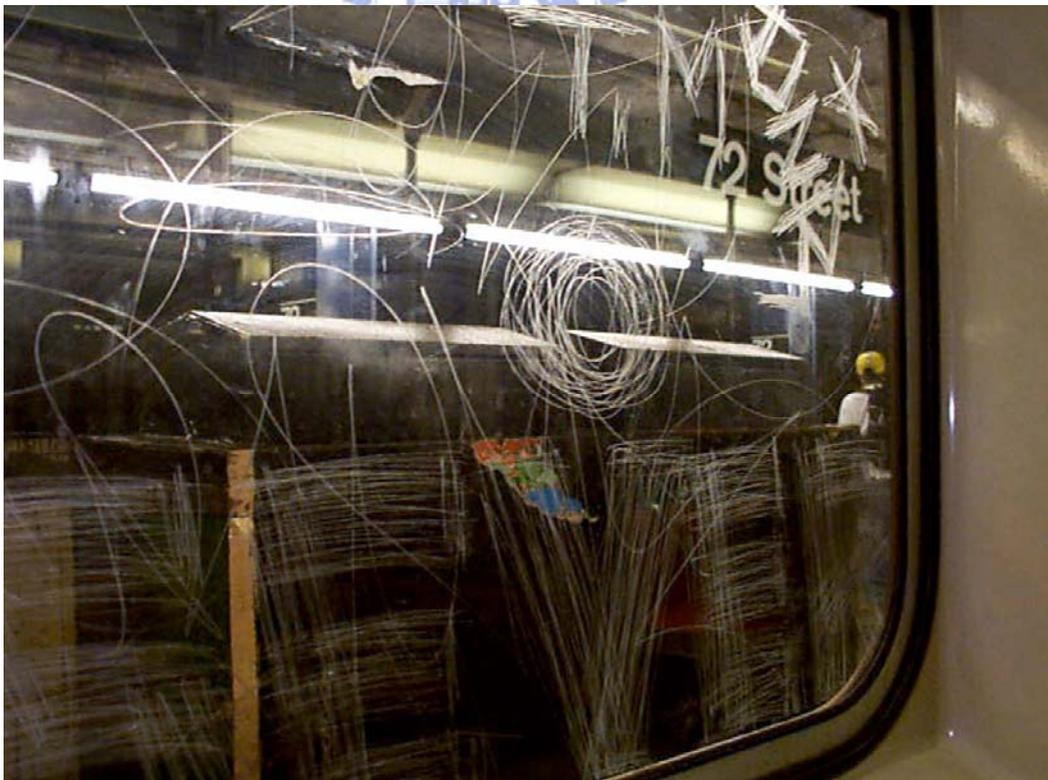
圖 1-1 地下鐵車窗刮痕的嚴重情形
