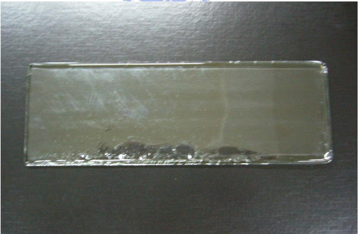
圖 5-4 Over - heated 的玻璃試片
