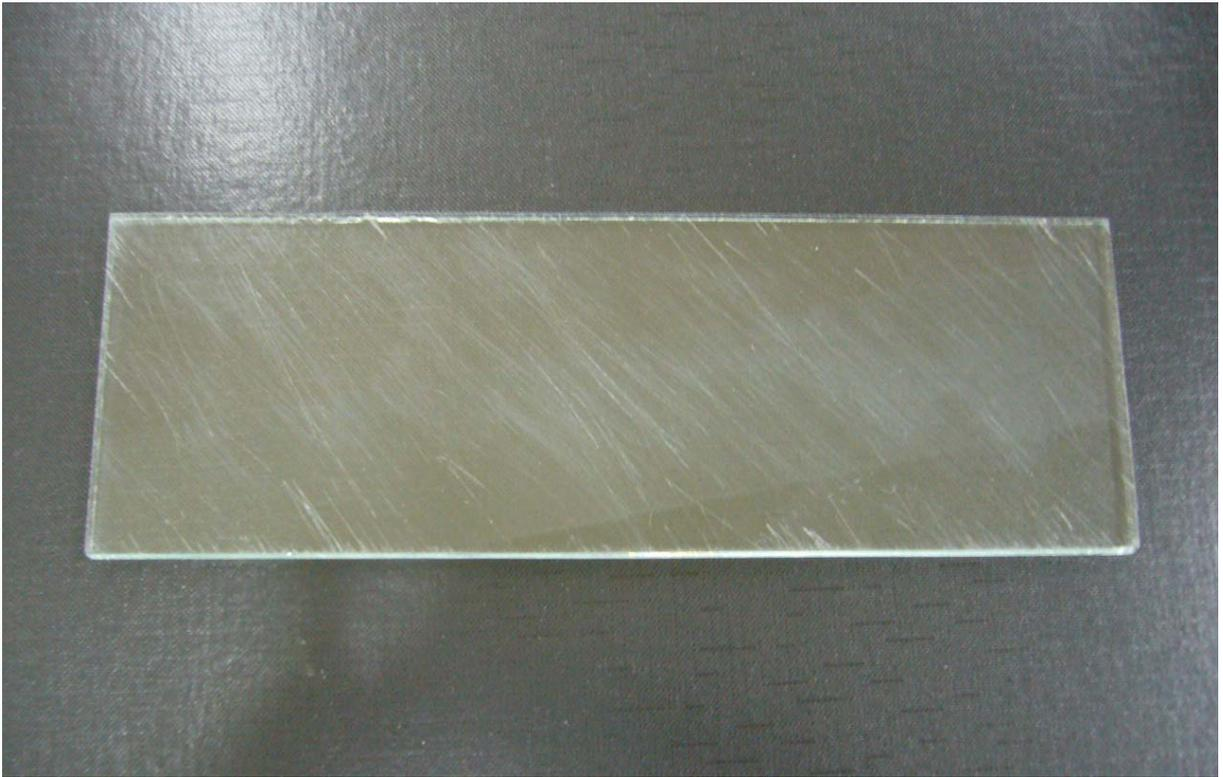
圖 5-1 火焰拋光前的玻璃試片
