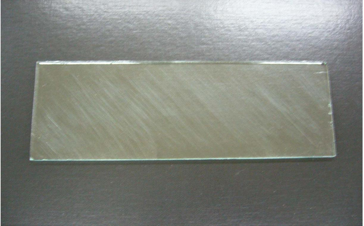
圖 5-3 火焰拋光前的玻璃試片
