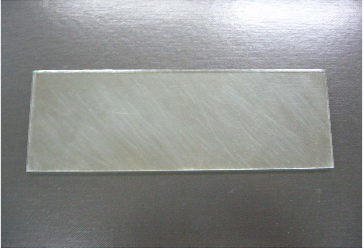
圖 5-11 火焰拋光前的玻璃試片
