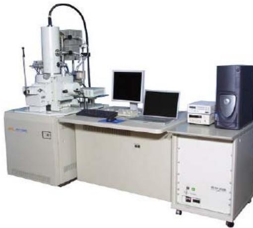
圖 3-11 掃描式電子顯微鏡(SEM)實體圖
