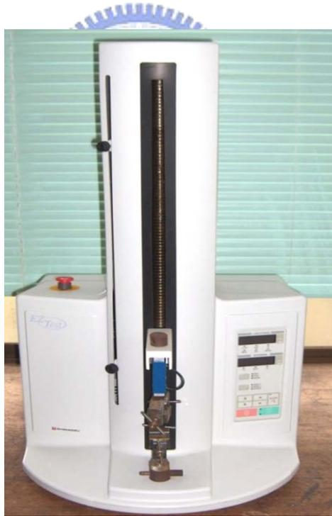
圖 3-10.萬能材料試驗機實體圖
