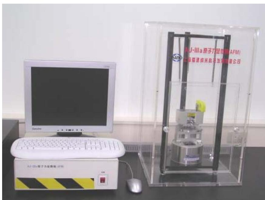
圖 3-6.原子力顯微鏡系統
