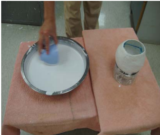
圖 1.23 頭盔製作過程 灌製石膏模[25]
