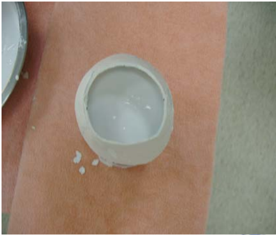
圖 1.24 頭盔製作過程 灌製石膏模[25]
