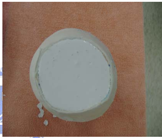
圖 1.24 頭盔製作過程 灌製石膏模[25]
