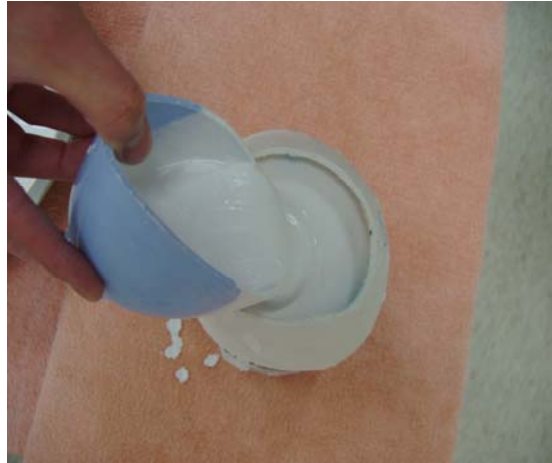
圖 1.23 頭盔製作過程 灌製石膏模[25]
