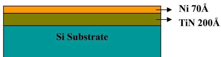
圖 4.22 垂直合成奈米碳管試片之結構示意圖
