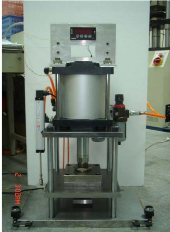
圖 4-2 剪斷機構
