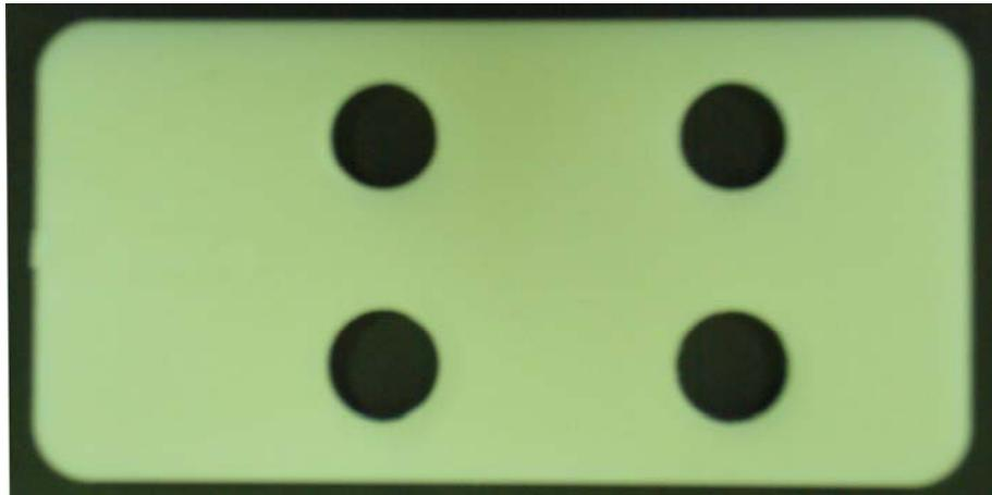
圖 5-14 模內沖孔成形品（材料為 ABS）
