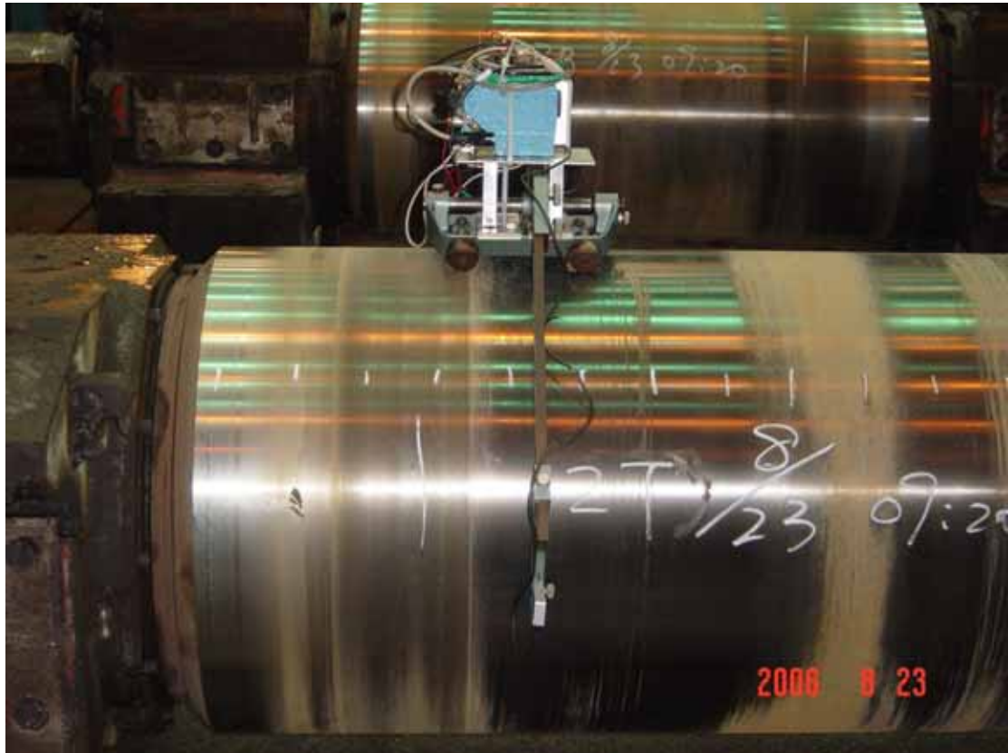
圖三 實際量測輥徑及溫度圖
