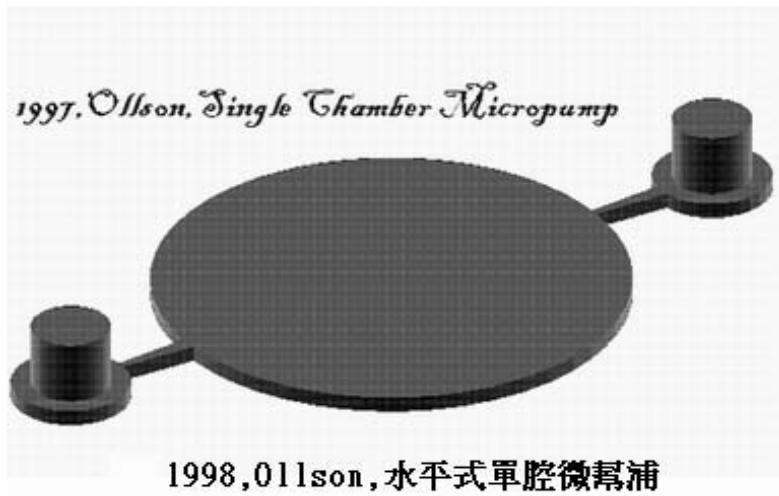
《圖 2.1》本文所欲分析的微幫浦的幾外形。圖為 1998 年，Ollson【5】所製單腔體圓形微幫浦示意圖
