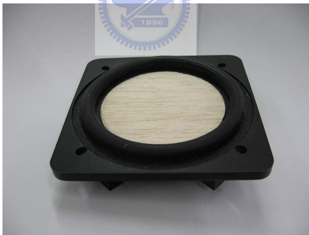
圖 1-2 振動板為平面的揚聲器
