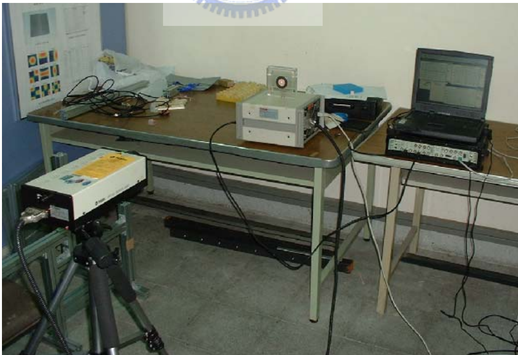
圖 6-3 阻尼比量測實驗架設示意圖
