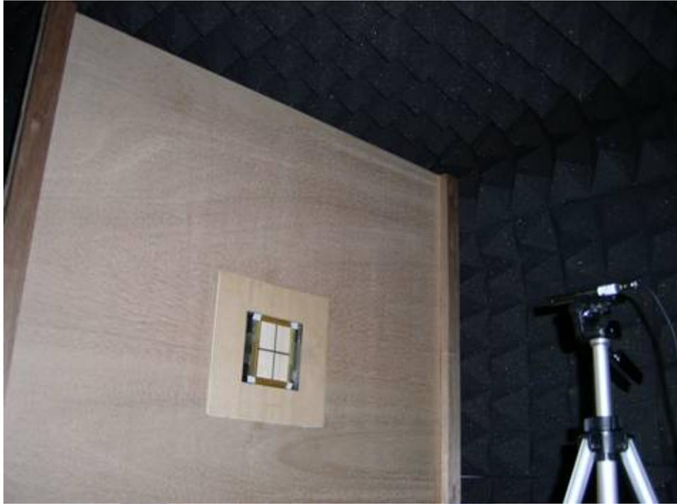
圖 4.30 聲壓實驗架設
