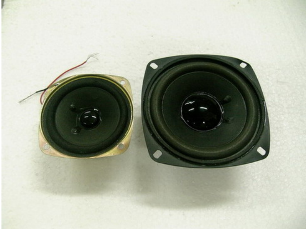
圖 1-1 傳統振動板為錐盆型的揚聲器
