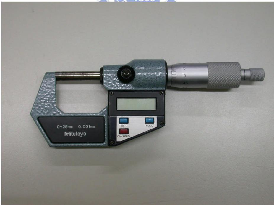
圖 3.5 螺旋測微計
