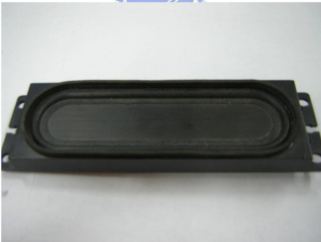
圖 1-2 振動板為平面式的揚聲器
