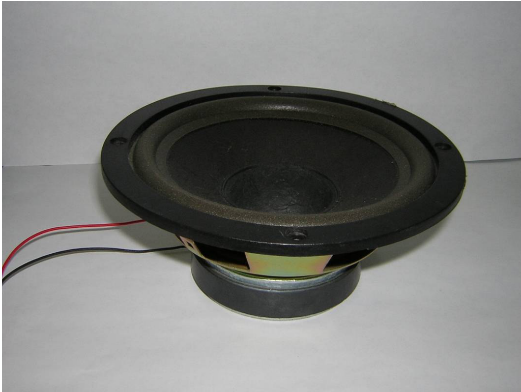
圖 1-1 傳統振動板為錐盆式的揚聲器
