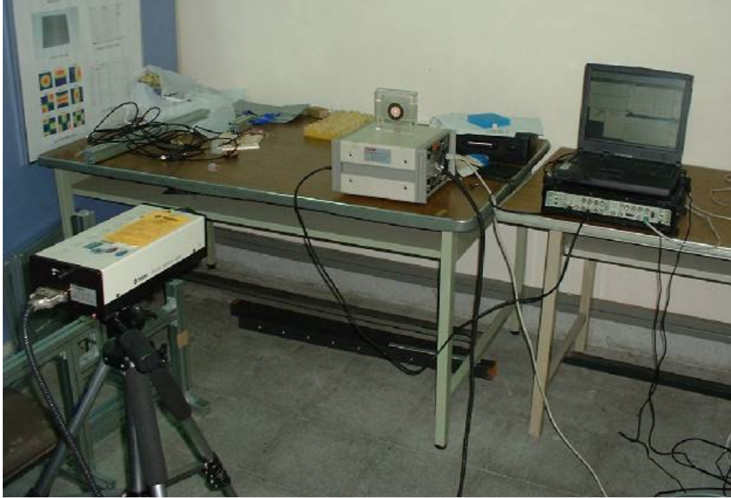
圖 4-17 阻尼比量測實驗架設圖
