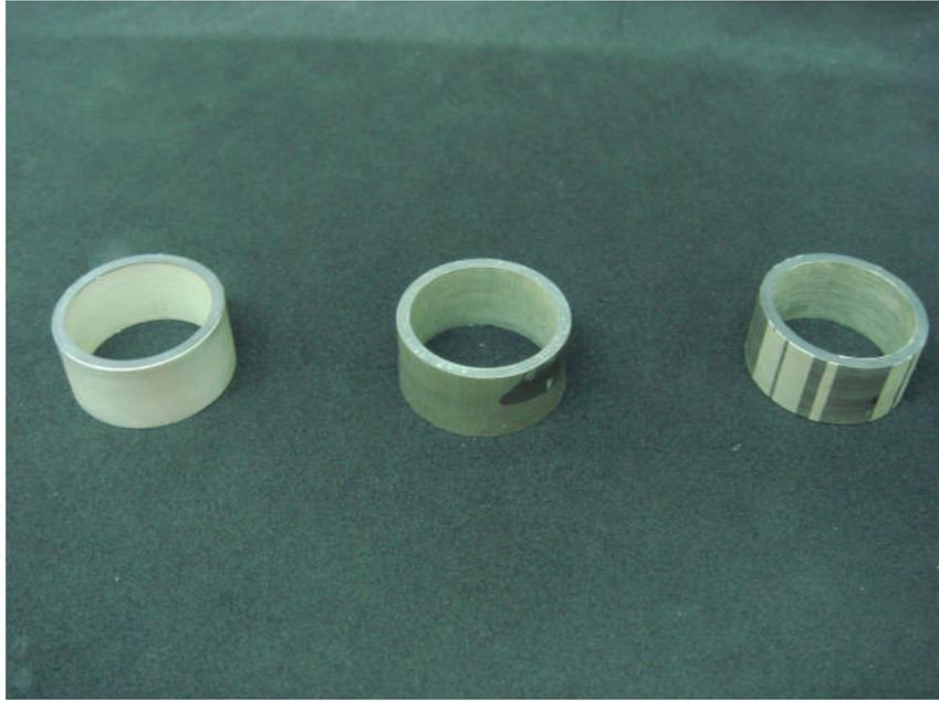
圖 3.3 PZT-4 壓電圓管(自左依序為清洗電極前、後及佈好設計之電極)
