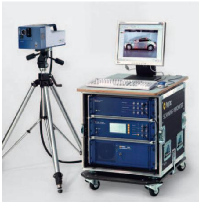
圖 3-11 都卜勒振動量測儀(Polytec Demo 設備)
