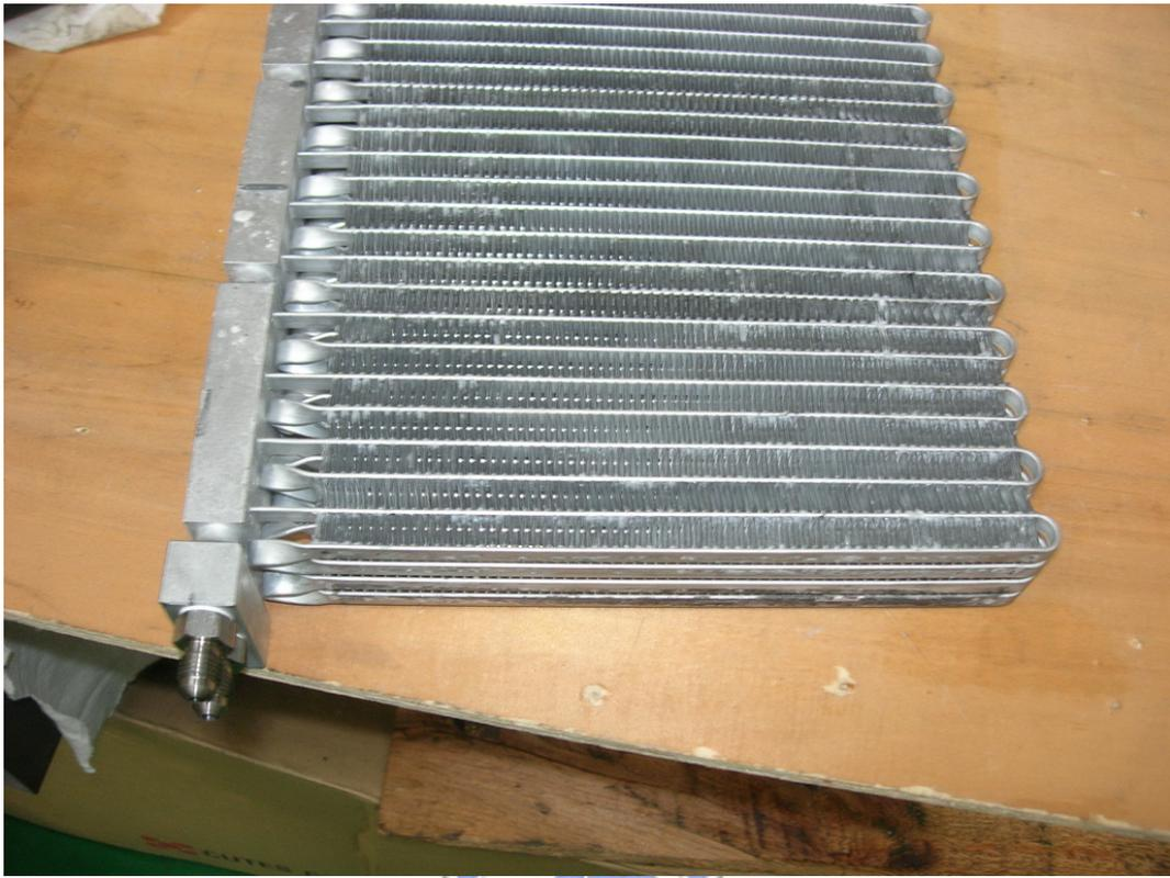
圖 1 - 16 焊接完成之 MPE tube 熱交換模組
