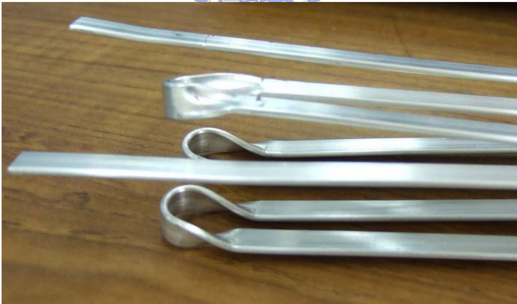
圖 1 - 15 MPE tube 使用制具變型後之成品
