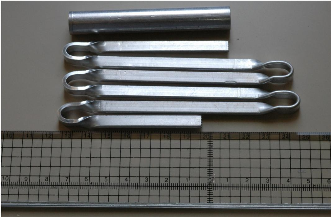
圖 1 - 12 多孔擠製管之折彎扭曲變形圖
