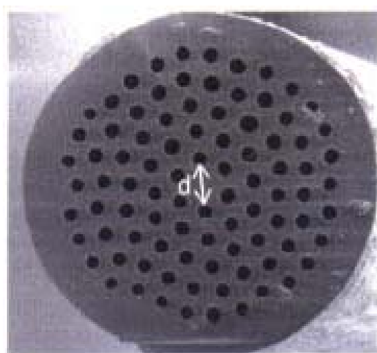
圖3-1-1-5 文獻中光子晶體光纖SEM剖面圖
