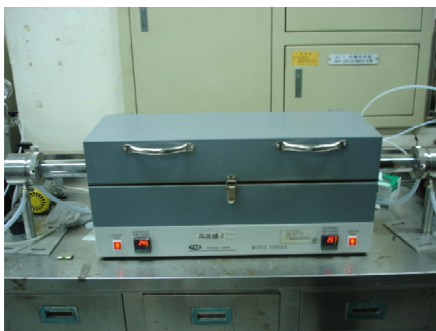
圖2-7-1 真空爐管系統實體圖
