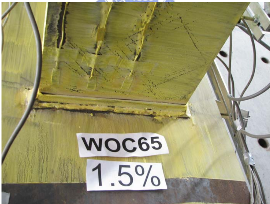
照片 4.5 試體 WOC65 梁下翼板之放射狀斑紋石灰剝落增加並往梁端的方向延伸 (1.5% drift)
