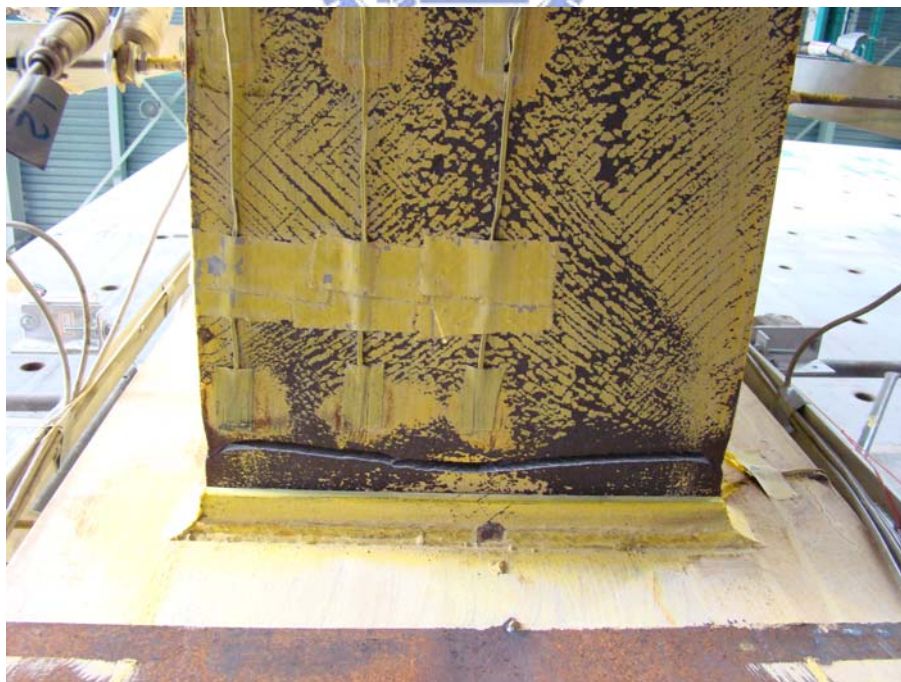
照片 4.30 試體 WOC65R2 梁翼板於扇形開孔處產生開裂並向兩側延伸導致整個下翼板斷裂 (3% drift)
