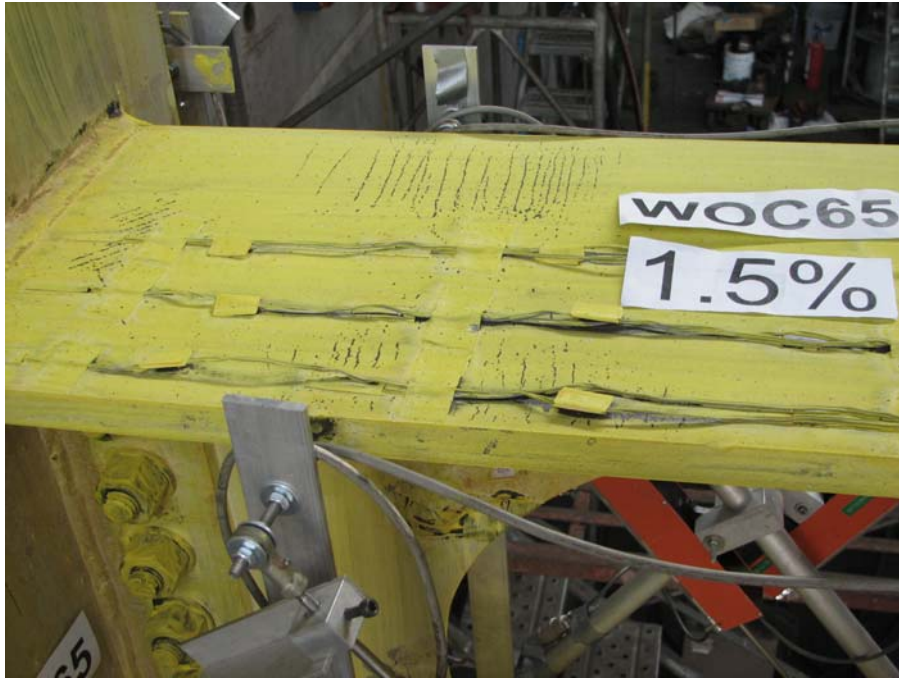
照片 4.4 試體 WOC65 上翼板距柱面約 250 mm 處開始出現與翼寬平行之橫向斑紋剝落 (1.5% drift)
