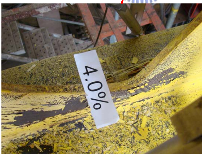
照片 4.22 試體 WOC50R1 梁腹板開孔中心周圍的石灰已幾乎完全掉落並出現嚴重面外挫屈的現象 (4% drift)
