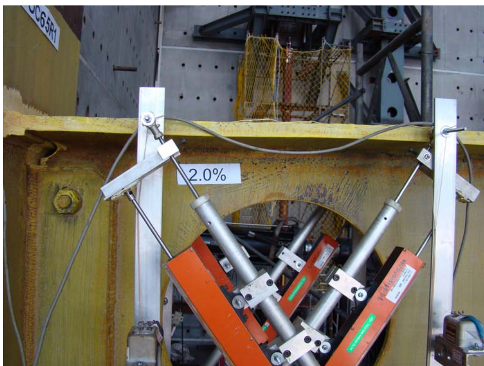
照片 4.12 試體 WOC65R1 上翼板開始出現輕微的挫屈 (2% drift)
