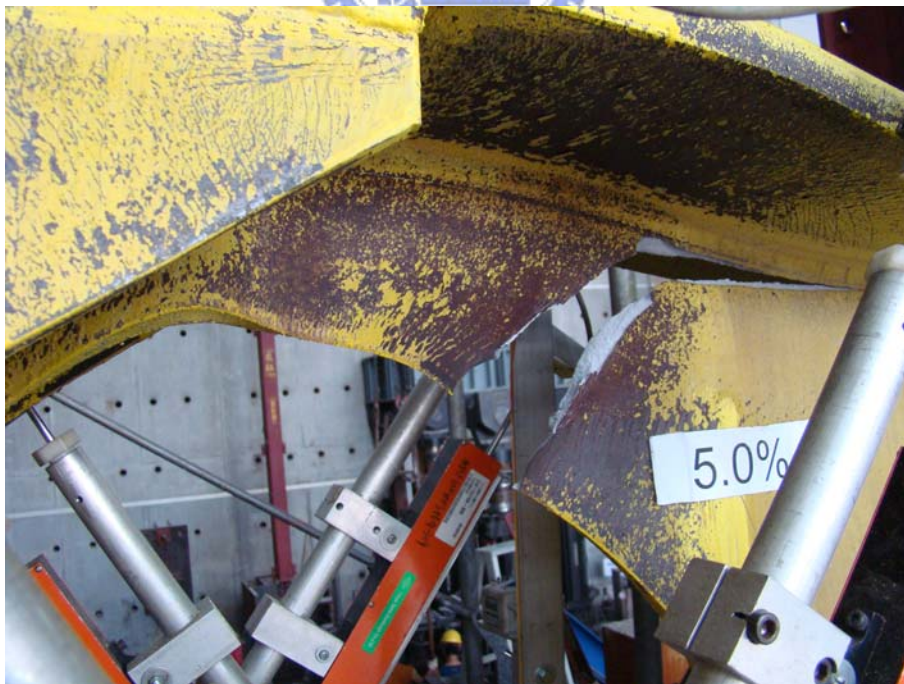
照片 4.39 試體 WOC65R3 梁腹開孔周圍的右上角已出現很大的裂縫 (5% drift)
