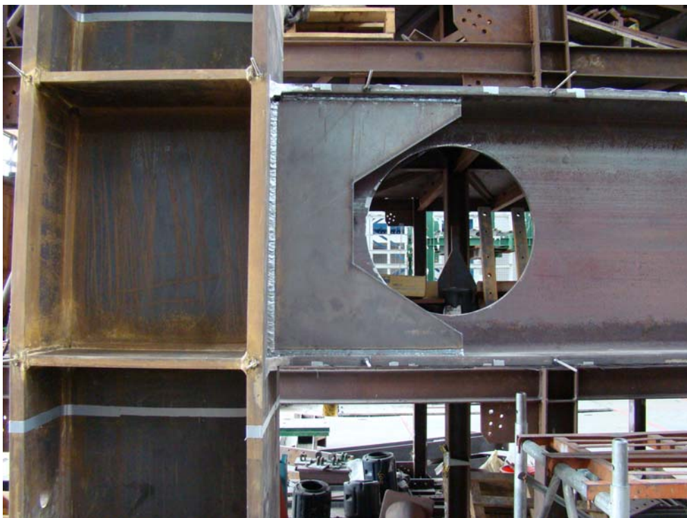
照片 3.11 加勁板僅在梁上翼處預留切角
