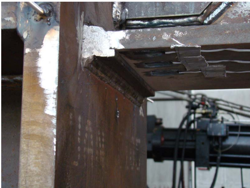
照片 3.13 上下翼板背墊板未移除，並在背墊板下方再增加填角銲(續)
