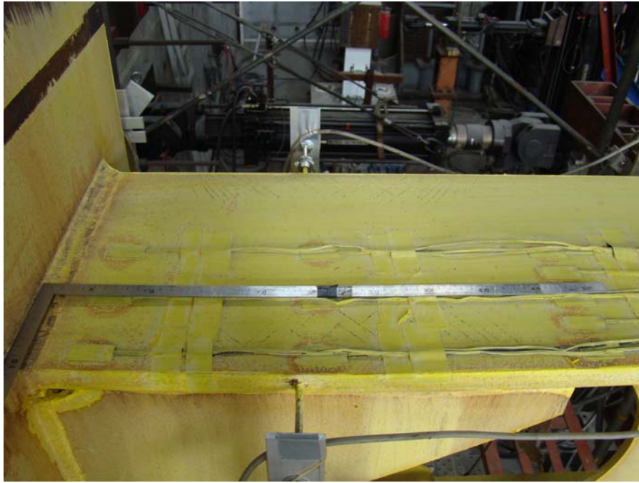
照片 4.23 試體 WOC65R2 梁上翼板邊緣處有與梁翼縱向呈 45 度石灰剝落現象發生 (0.75% drift)
