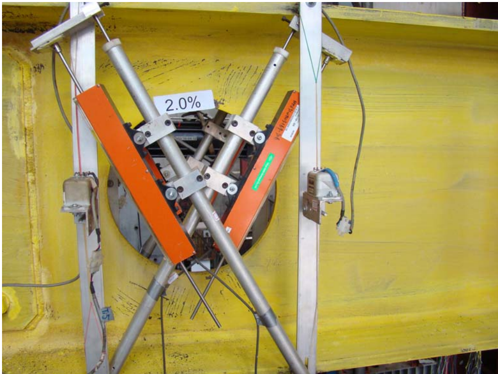
照片 4.20 試體 WOC50R1 梁腹板開孔周圍石灰剝落的情況持續以開孔圓心為基準的對角線方向往梁腹板開孔兩側向翼板延伸(類似交叉狀) (1.5% drift)
