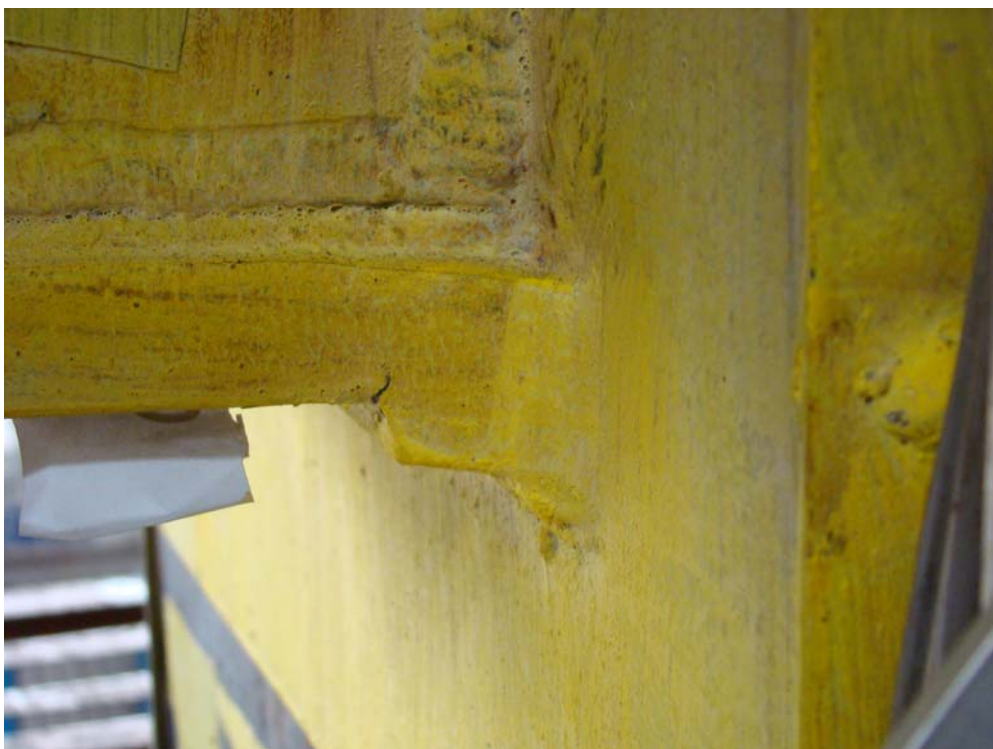
照片 4.36 試體 WOC65R3 下翼板邊緣之全滲透鉚道處出現很小的裂縫 (4% drift)
