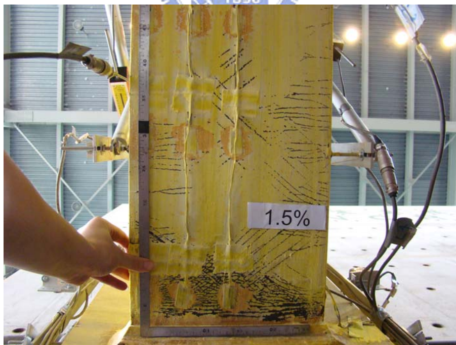
照片 4.19 試體 WOC50R1 下翼板邊緣處開始有橫向斑紋石灰剝落且在翼板中心處有斜向石灰剝落的現象產生 (1.5% drift)
