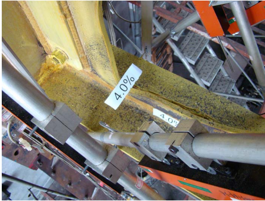
照片 4.14 試體 WOC65R1 梁腹板開孔成橢圓形狀，並出現嚴重的面 外挫屈 (4% drift)
