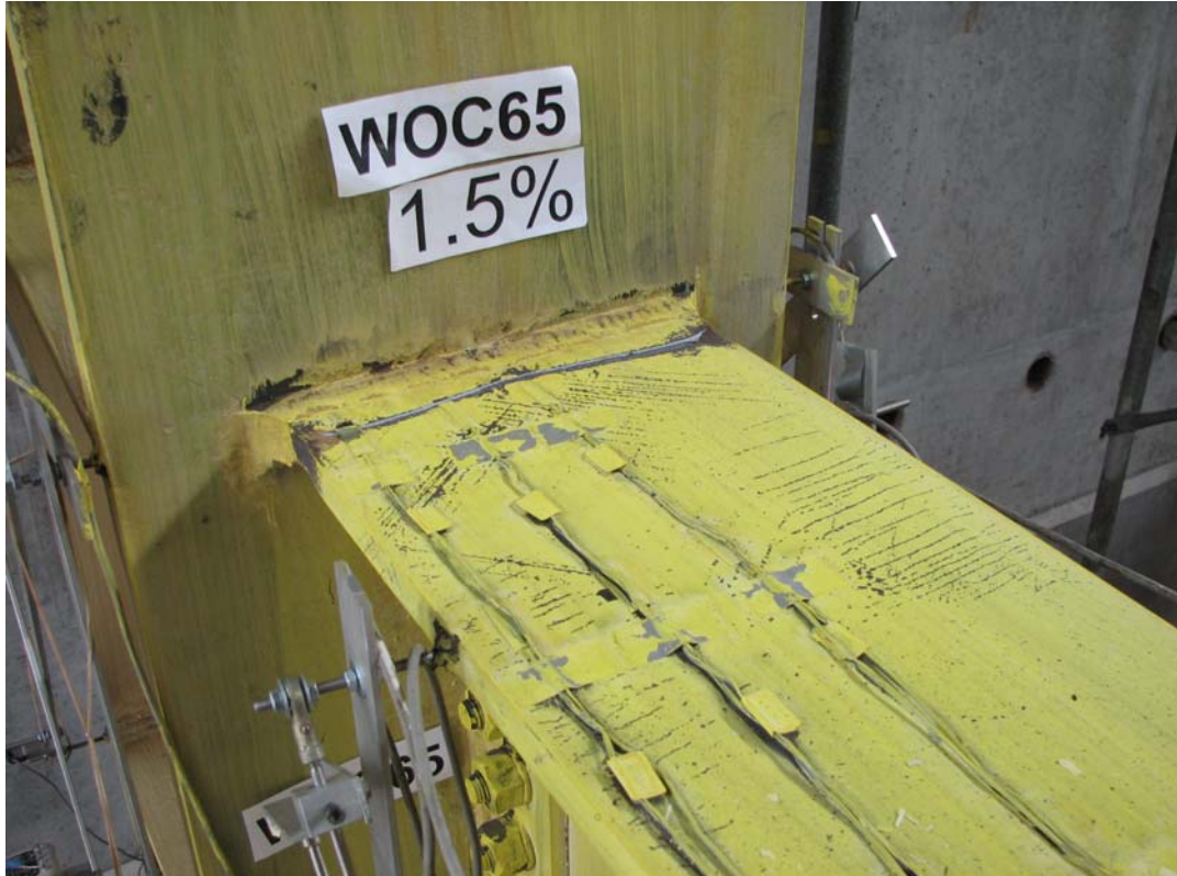
照片 4.6 試體 WOC65 梁翼板於扇形開孔處產生開裂並向兩側延伸導致整個上翼板斷裂 (1.5% drift)
