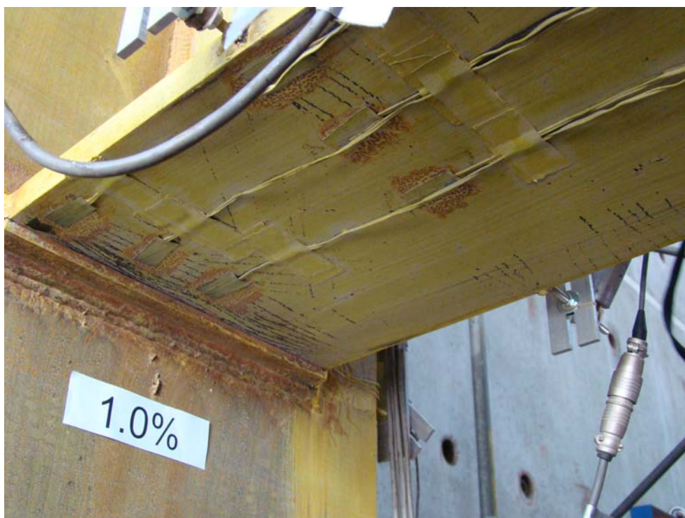
照片 4.10 試體 WOC65R1 下翼板在上翼板相同位置處也開始出現橫向斑紋石灰剝落 (1% drift)
