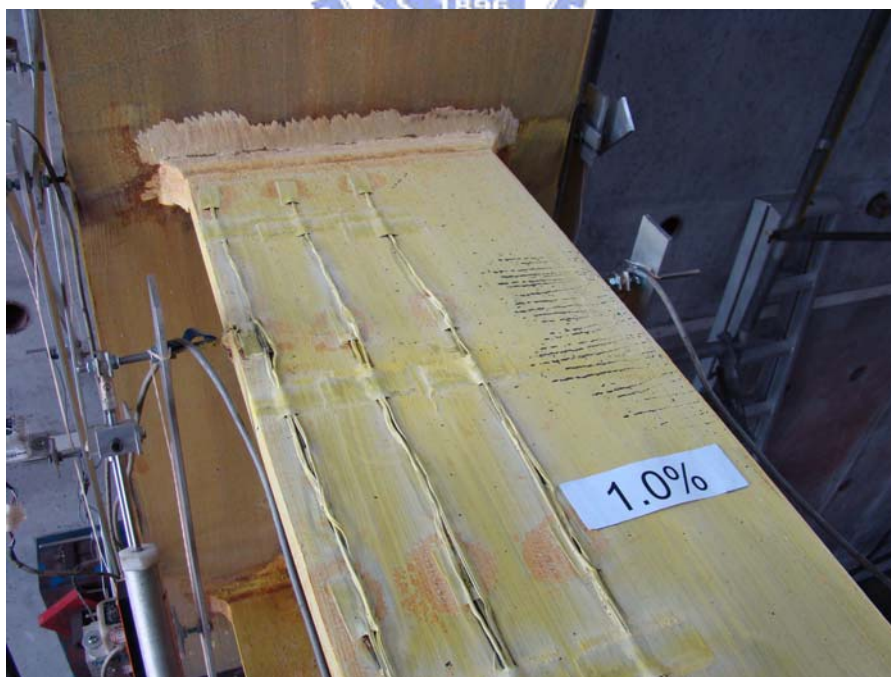
照片 4.9 試體 WOC65R1 上翼板邊緣平行翼寬之橫向斑紋石灰剝落開 始往內側增加 (1% drift)
