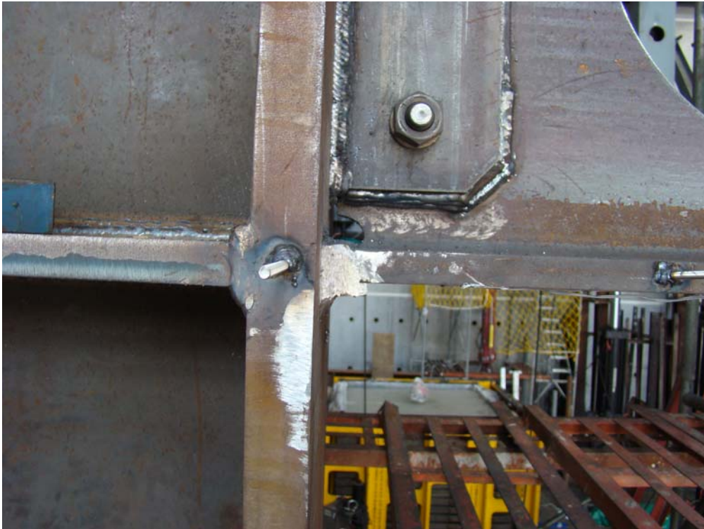
照片 3.5 柱翼板與剪力板開槽鉚加填角鉚，梁腹與剪力板填角鉚(續)
