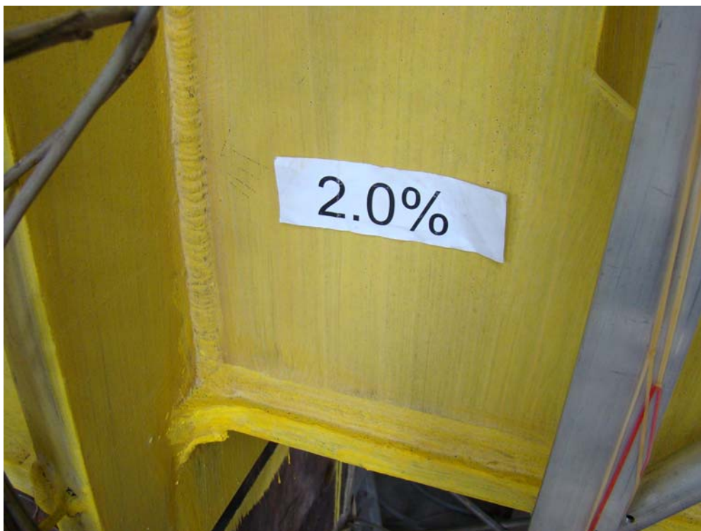
照片 4.34 試體 WOC65R3 加勁板開始有些許的石灰剝落 (2% drift)
