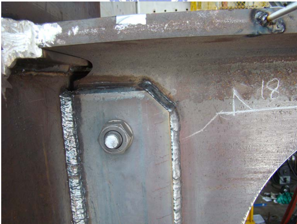
照片 3.4 柱翼板與剪力板開槽銲加填角銲，梁腹與剪力板填角銲(續)
