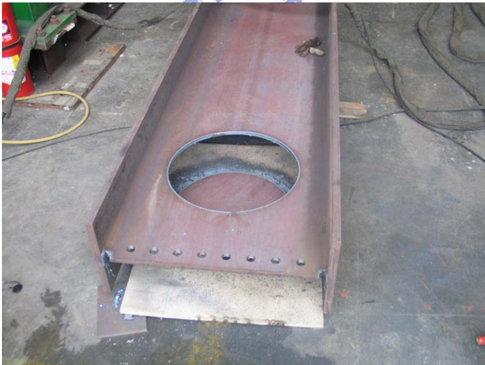
照片 3.2 梁腹板開一個直徑為 0.65 倍梁深的圓孔(續)
