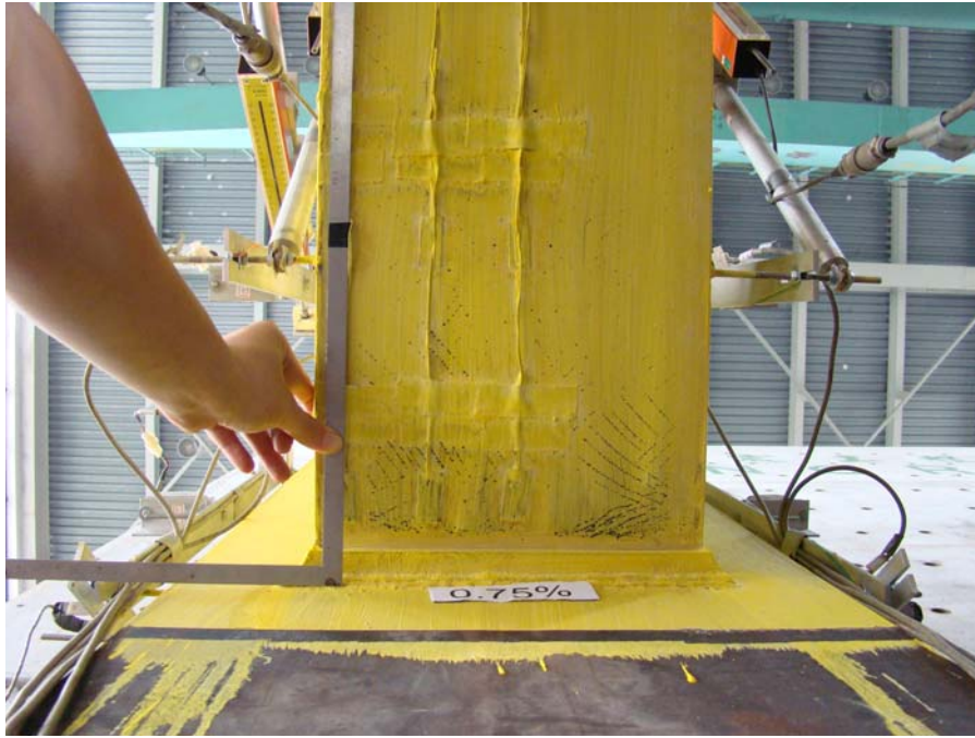
照片 4.31 試體 WOC65R3 下翼板在靠近柱面處的石灰剝落的情況沒有像 WOC65R2 如此嚴重 (0.75% drift)
