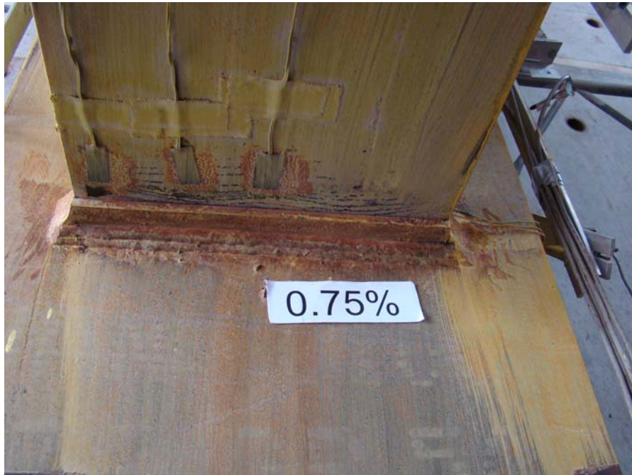
照片 4.8 試體 WOC65R1 下翼板於柱面背墊板處出現類似 V 字型的 斑紋石灰剝落 (0.75% drift)
