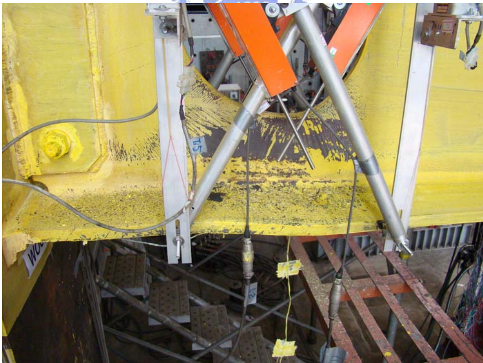
照片 4.21 試體 WOC50R1 上、下翼板挫屈已非常明顯 (4% drift)
