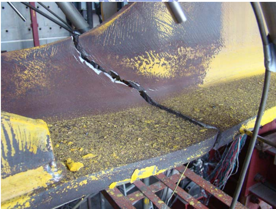
照片 4.41 試體 WOC65R3 加勁板與梁下翼板全滲透銲接的端部(開孔中心)往梁端方向之下翼板發生撕裂並延伸到梁腹板開孔 (5% drift)
