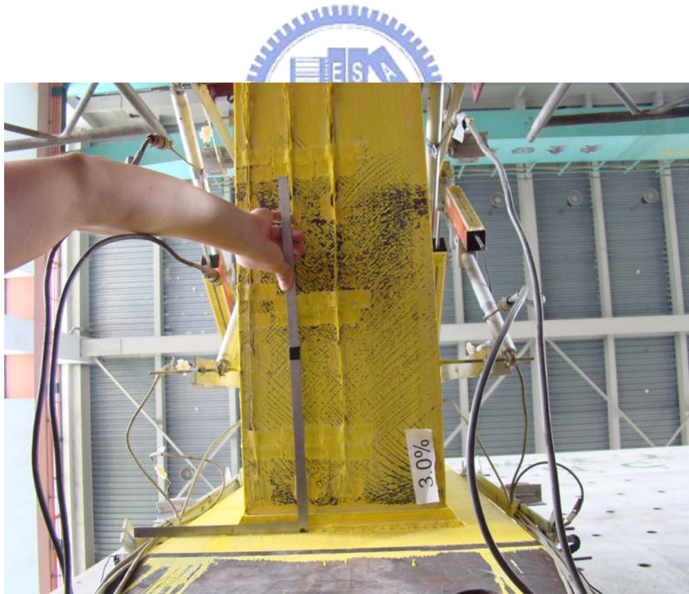
照片 4.35 試體 WOC65R3 上、下翼板石灰剝落的情況由局部演變為大範圍剝落 (3% drift)
