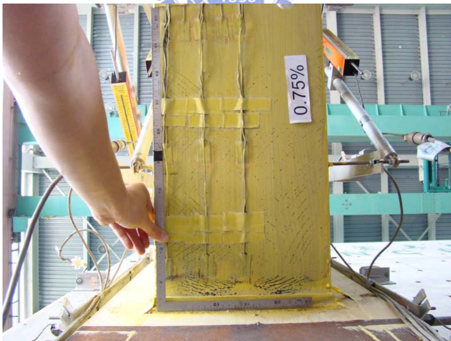
照片 4.24 試體 WOC65R2 下翼板近柱面處出現 V 字型斑紋，且與上翼板相同範圍處有放射狀的斑紋剝落 (0.75% drift)
