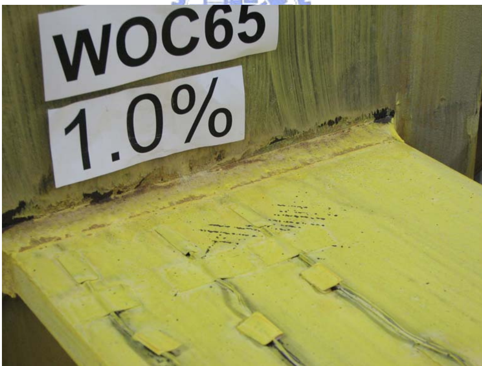
照片 4.1 試體 WOC65 接近梁上翼全滲透銲道之梁腹扇形開孔處開始 降伏，呈交叉狀斑紋剝落 (1% drift)
