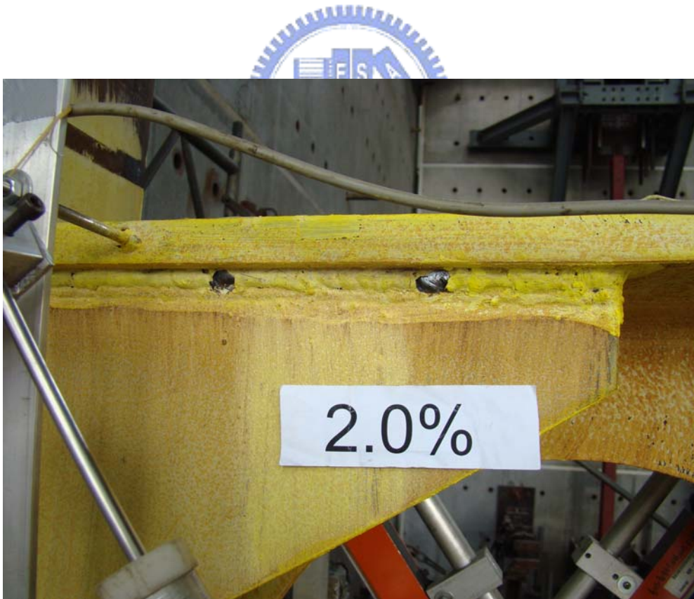
照片 4.26 試體 WOC65R2 加勁板與梁上翼板全滲透銲接處開始有石 灰剝落 (2% drift)
