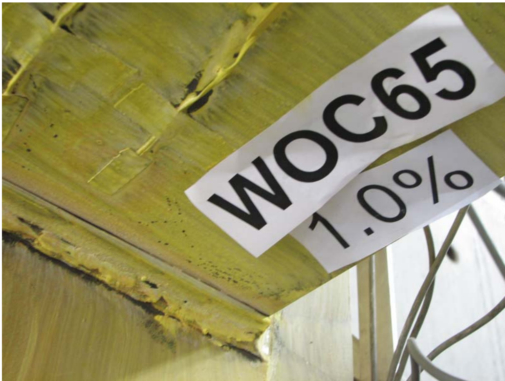
照片 4.2 試體 WOC65 下翼板表面石灰呈放射狀斑紋剝落 (1% drift)
