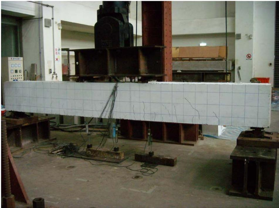
照片 4.1 N1 試體兩側之剪力裂縫
