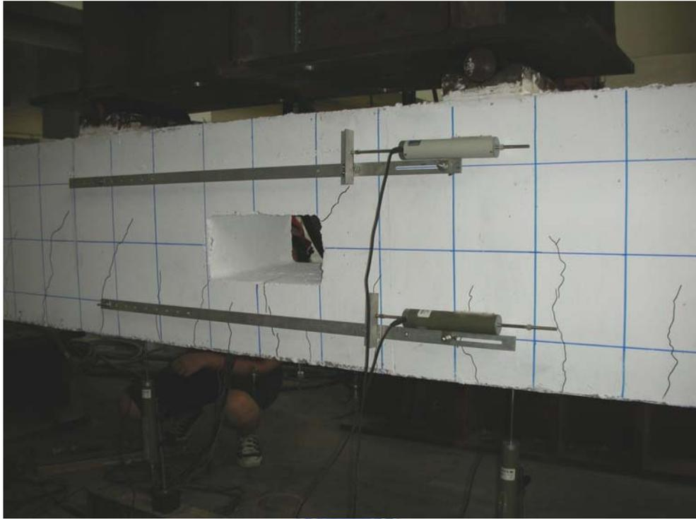
照片 4.14 R1 試體開孔角隅處之裂縫
