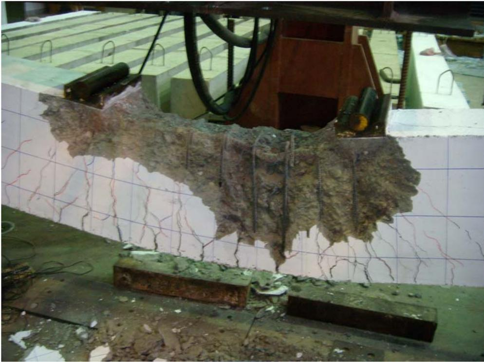
照片 4.48 N1 試體箍筋與鋼骨對混凝土之圍束情形
