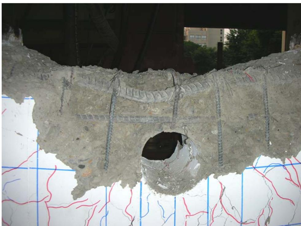
照片 4.50 C1 試體箍筋與鋼骨對混凝土之圍束情形
