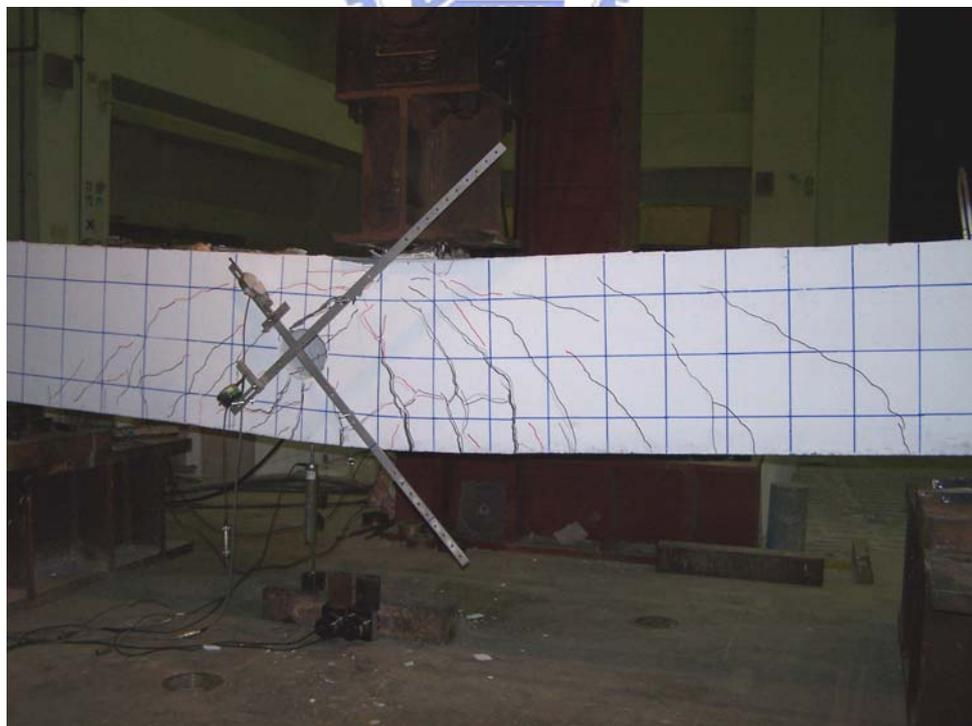
照片 4.29 C2 試體極限載重破壞時之狀態
