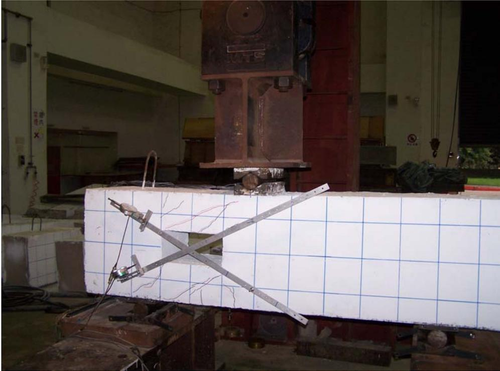
照片 4.44 R4 試體開孔角隅處之剪力裂縫
