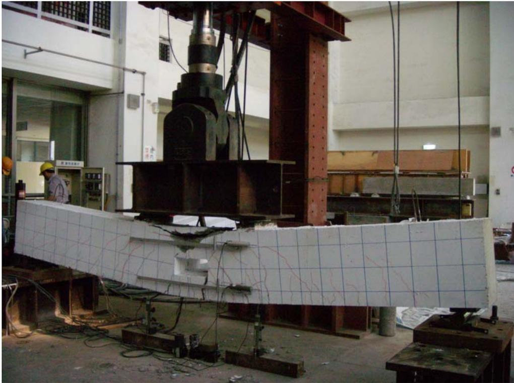
照片 4.16 R1 試體極限載重破壞時之狀態
