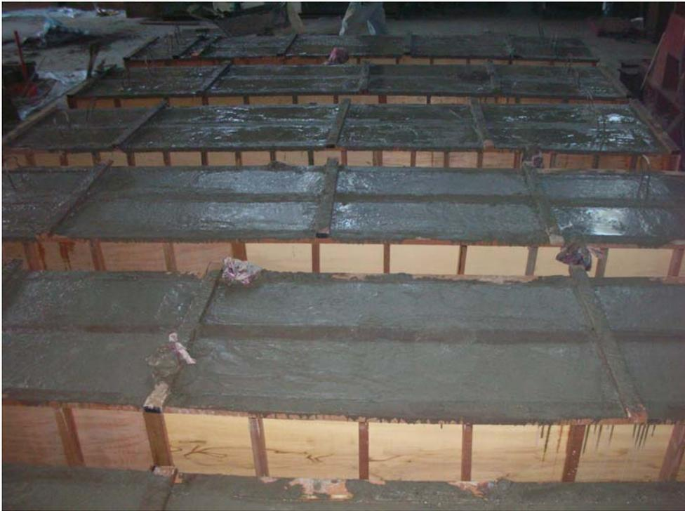
照片 3.6 試體灌漿後抹平
