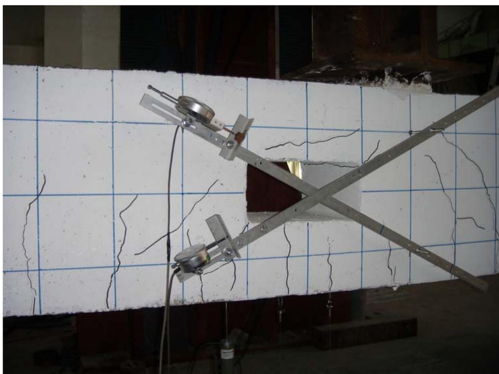
照片 4.38 R2 試體開孔角隅處之剪力裂縫
