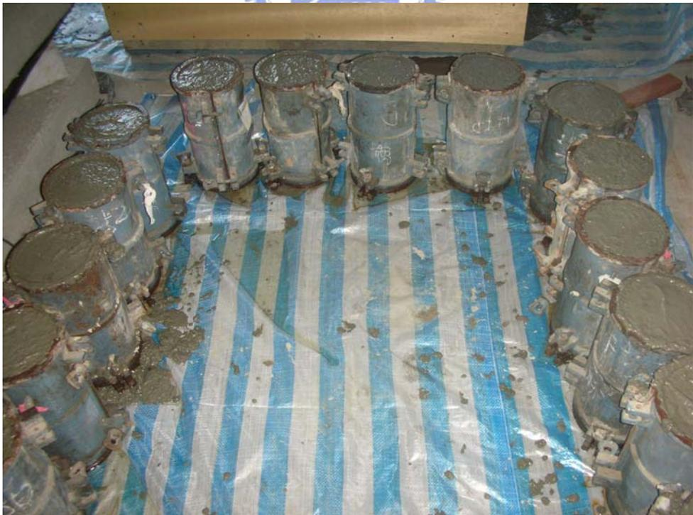
照片 3.7 製作圓柱抗壓試體
