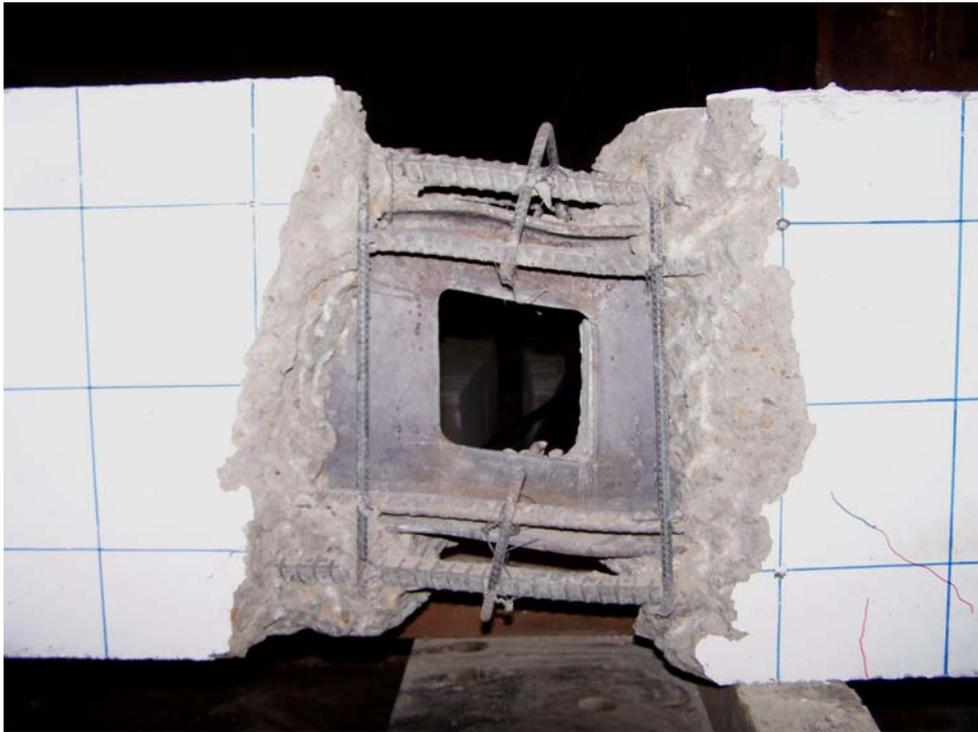
照片 4.26 S4 試體極限載重破壞後之剪力變形照
