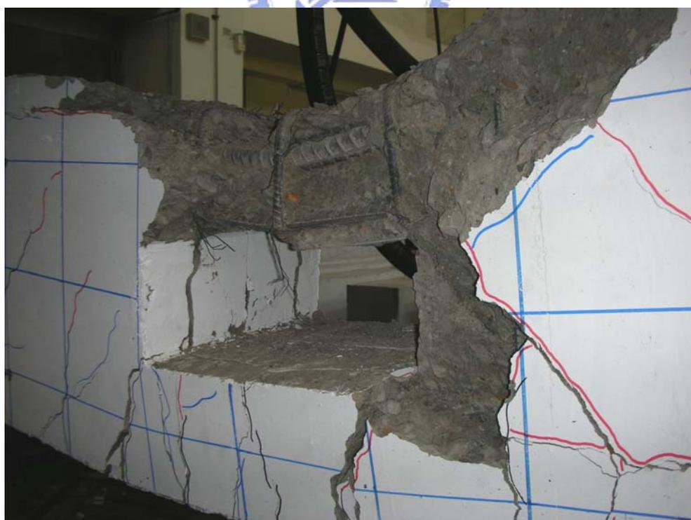
照片 4.51 R1 試體箍筋與鋼骨對混凝土之圍束情形
