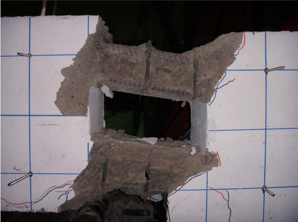
照片 4.46 R4 試體極限載重破壞後之剪力變形
