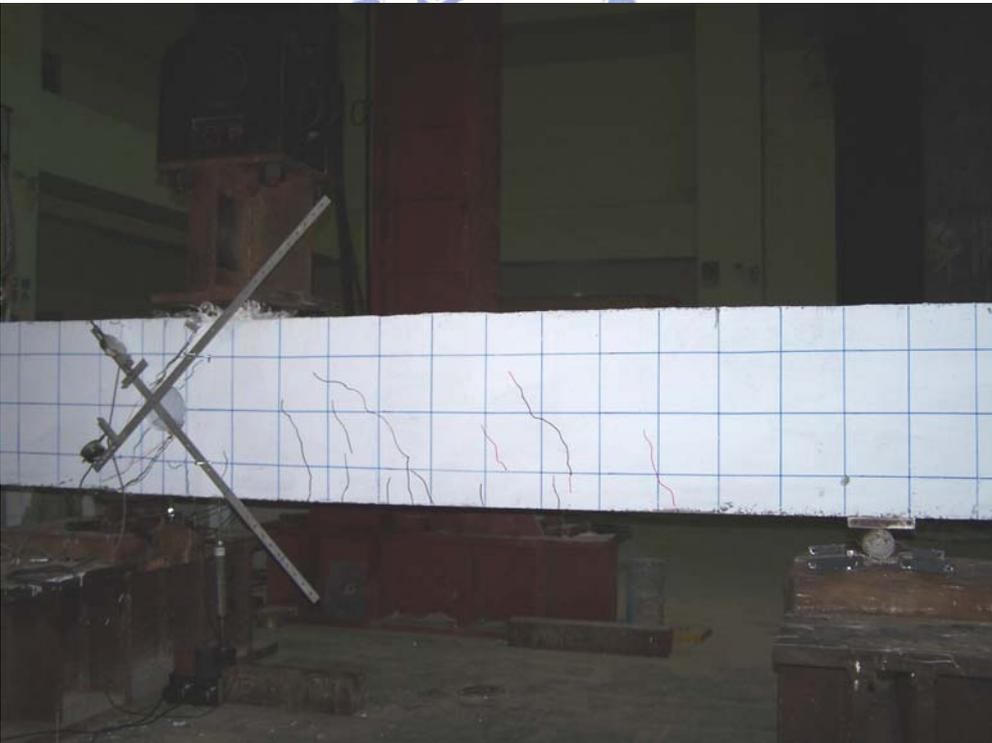
照片 4.35 C4 試體極限載重破壞時之狀態
