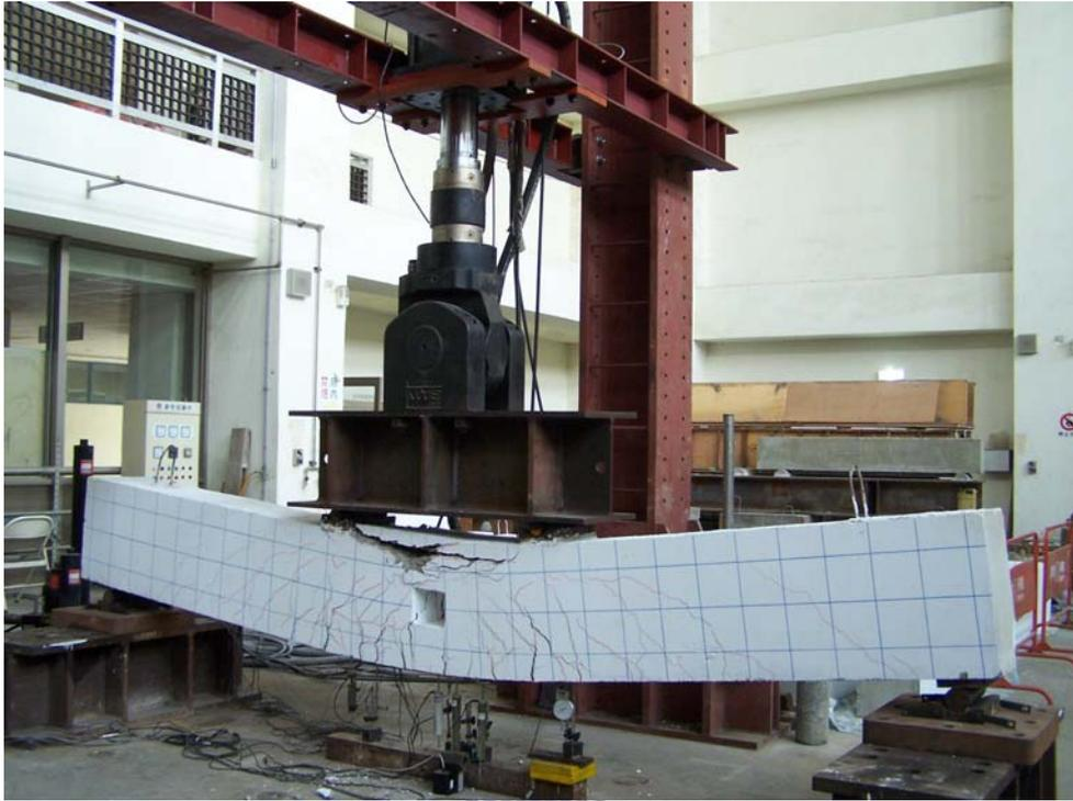
照片 4.8 S1 試體極限載重破壞時之狀態
