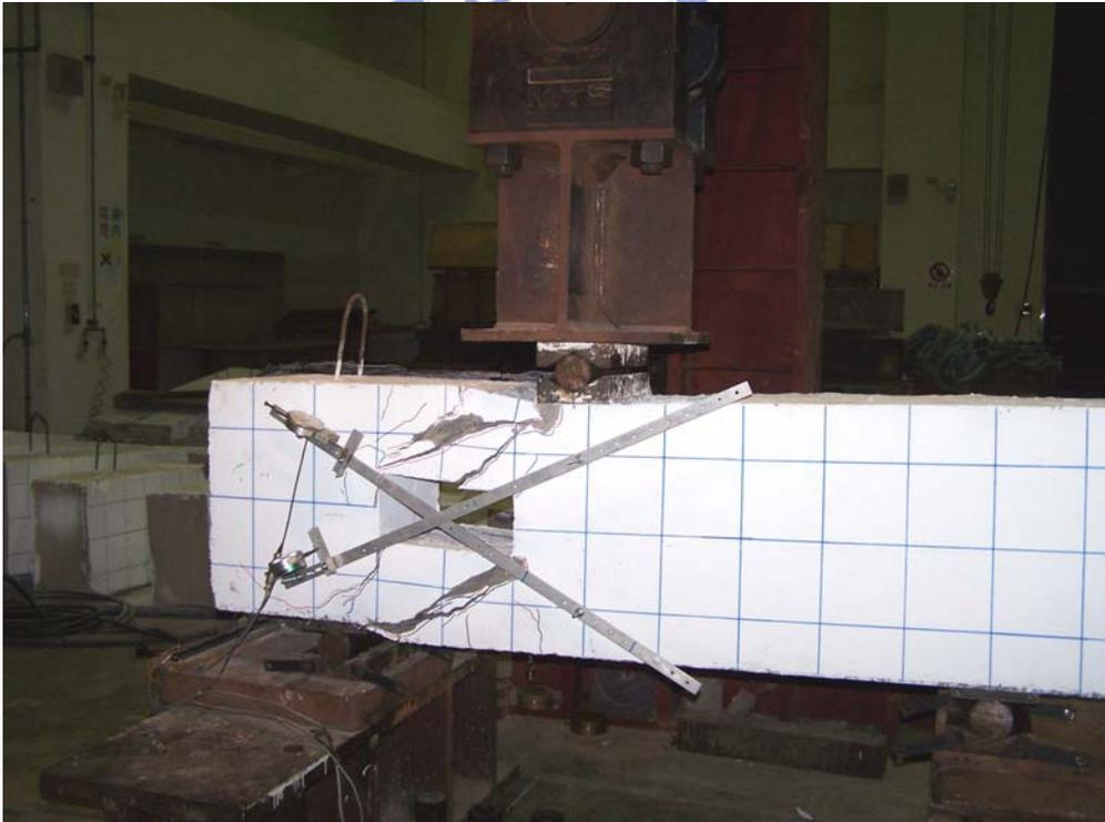
照片 4.45 R4 試體極限載重破壞時之狀態
