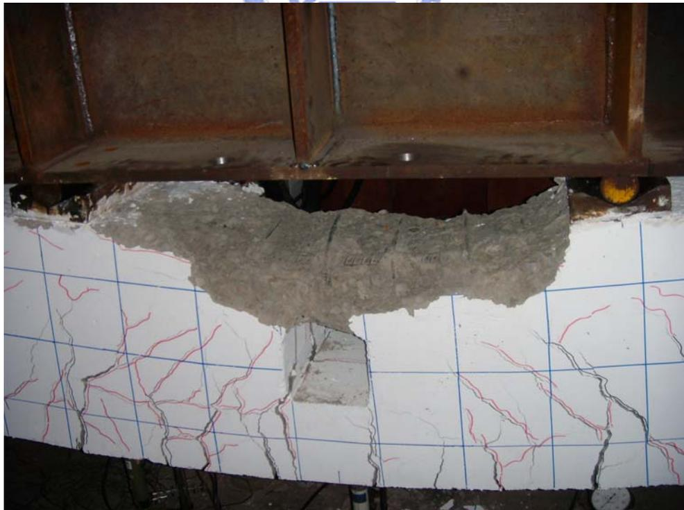
照片 4.49 S1 試體箍筋與鋼骨對混凝土之圍束情形
