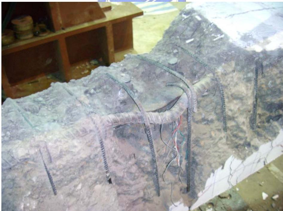
照片 4.4 N1 試體極限載重破壞時主筋及鋼骨上翼板挫屈
