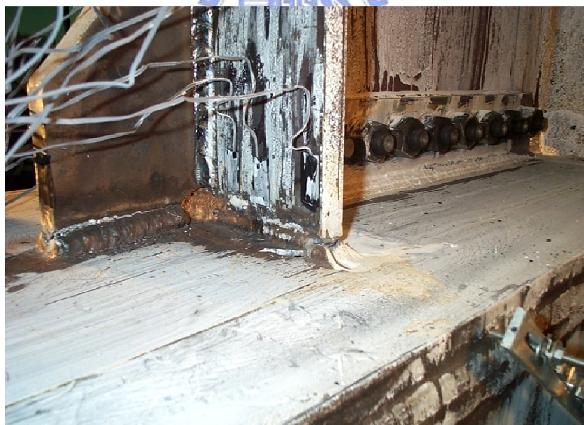
照片 2.3 試體 BUN 扇形開口根部撕裂破壞 (4.0% rad)
