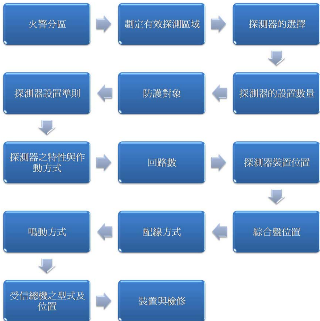
圖 2-20 火警自動警報設備設計流程圖
