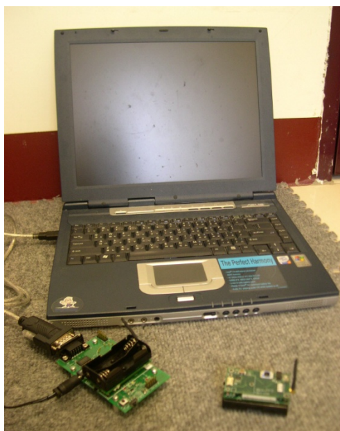
圖 2-12 無線感測系統的硬體架構
