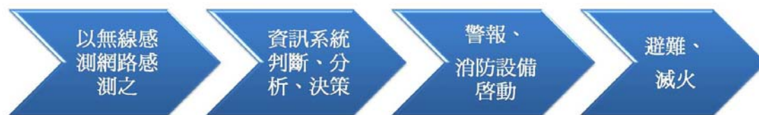
圖 3-11 「無線感測網路應用於建築物防火資訊系統」系統運作之流程圖
