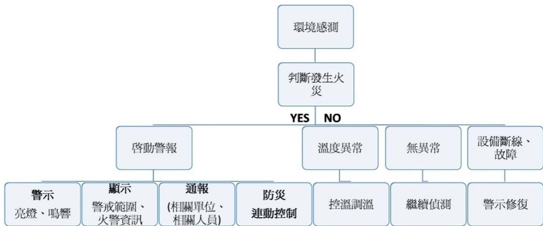
圖 3-13 「無線感測網路應用於建築物防火資訊系統」之防火設計流程圖
