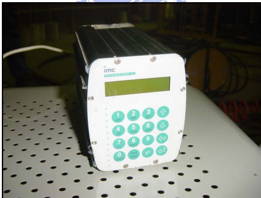
圖 3.22 IMC 資料擷取系統
