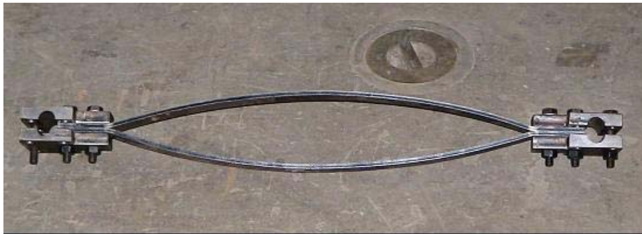
圖 1.8 挫屈連桿 (buckled struts) 元件【10】
