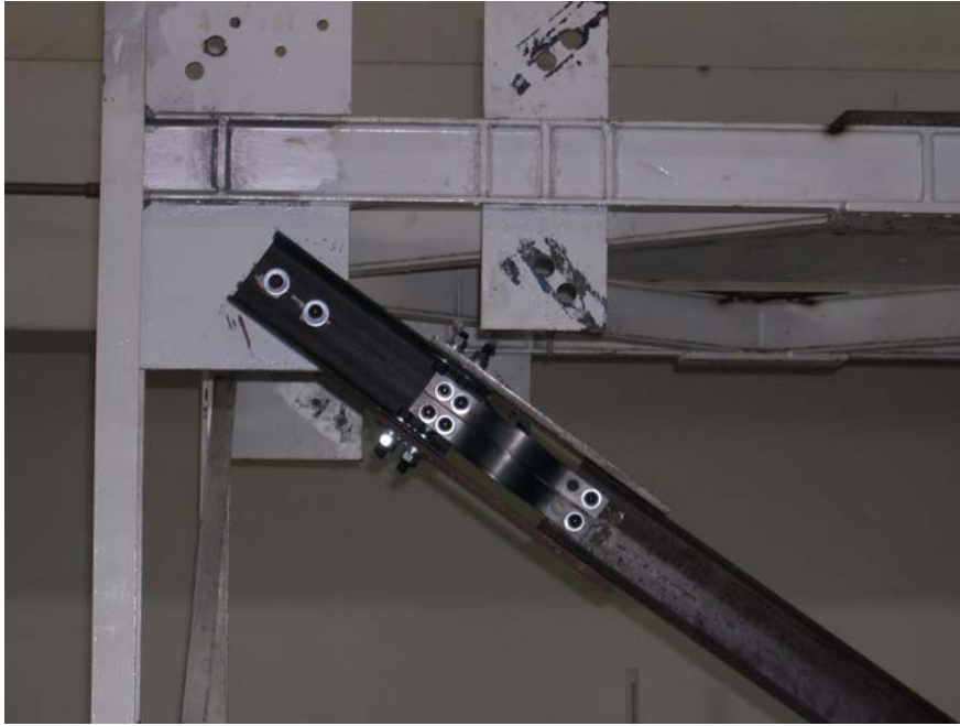
圖 4.80 挫屈型消能斜撐阻尼器（局部）
