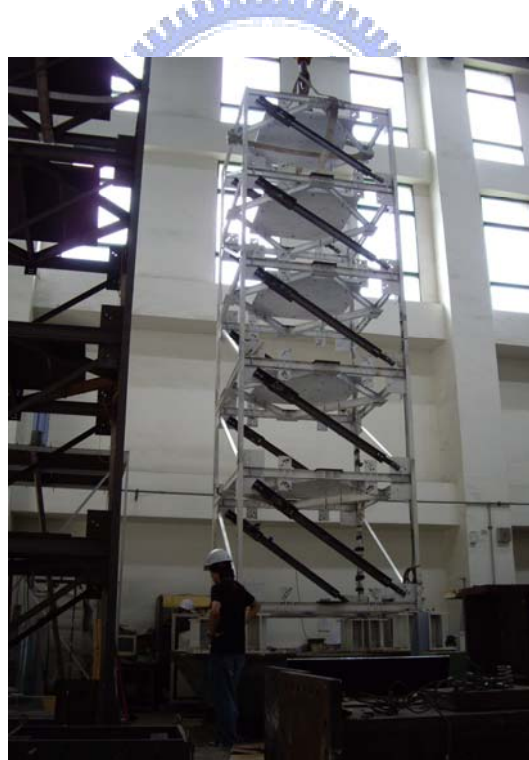
圖 4.80 挫屈型消能斜撐阻尼器（局部）
