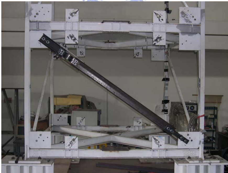
圖 4.79 挫屈型消能斜撐阻尼器
