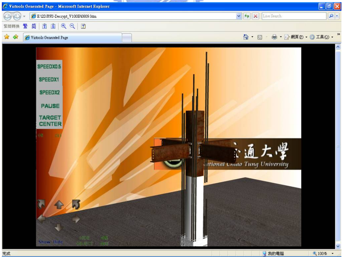
圖6-7 主筋於柱中間段續接
