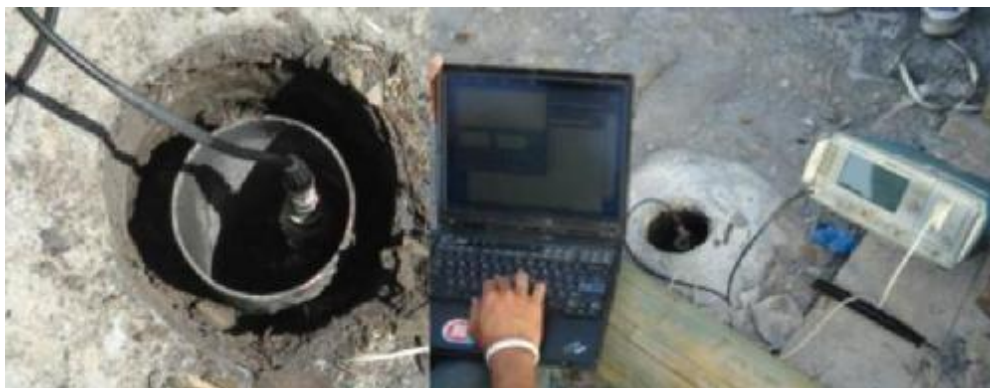
圖 3.35 量測訊號轉接(左)與 TDR 資料讀取(右)
