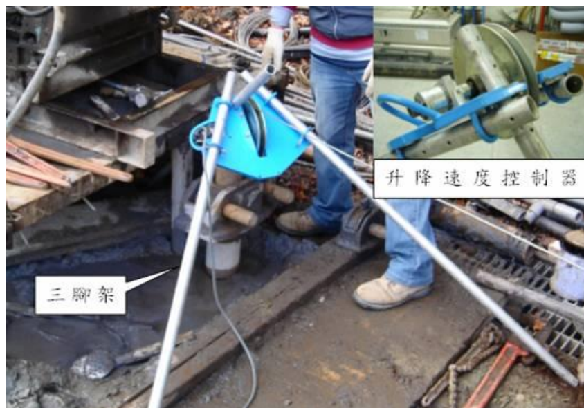
圖 3.16 三腳架與升降速度控制器架設
