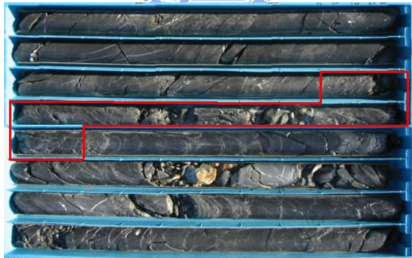
圖 4.32 剪裂帶(18.8~20.2m)之岩心照片
