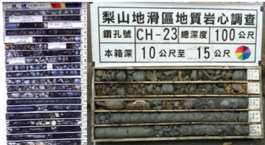
圖 2.26 CH-23 鑽孔 10m~15m 岩心照片(工研院能資所，1996)
