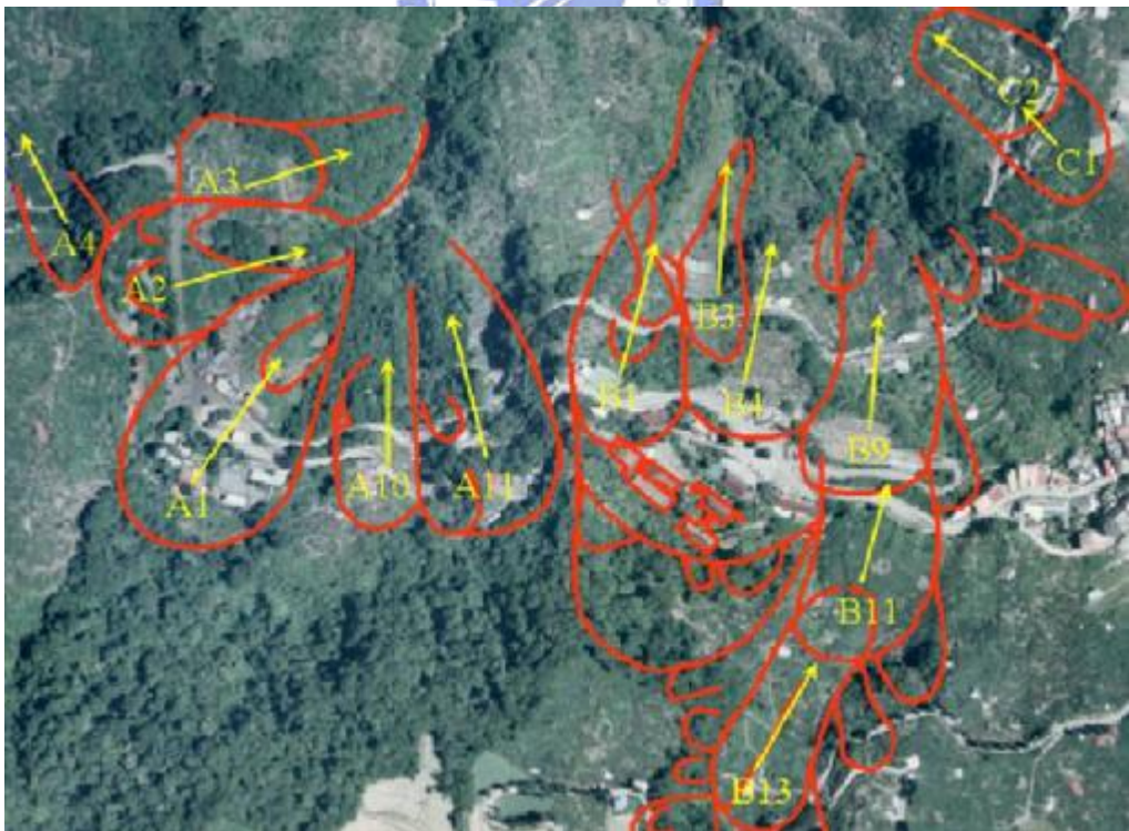
圖 5.17 推估各滑動體滑動方向
