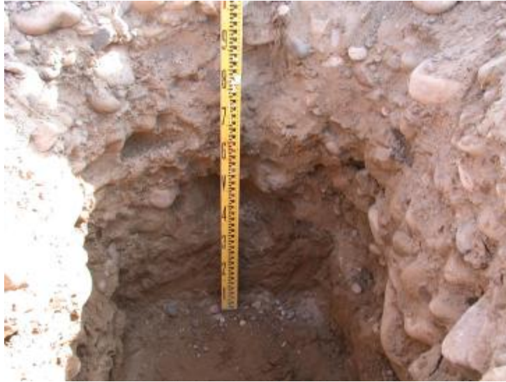
圖 4-22 鳳山溪體積法 95FS_02DaR_V010 試坑
