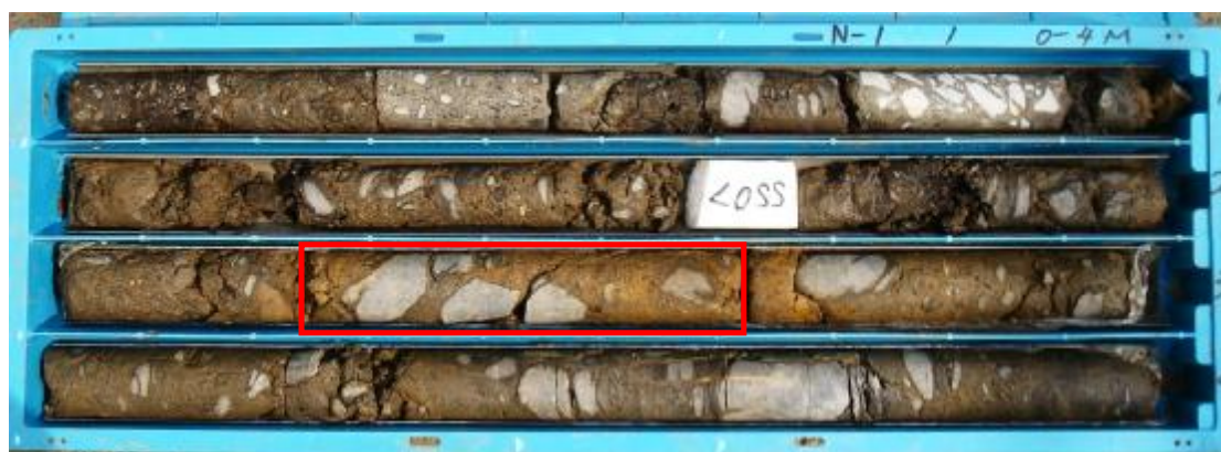
圖 3-5 鑽探岩心圖崩積土併構岩 N-1 2.25~2.6 m
