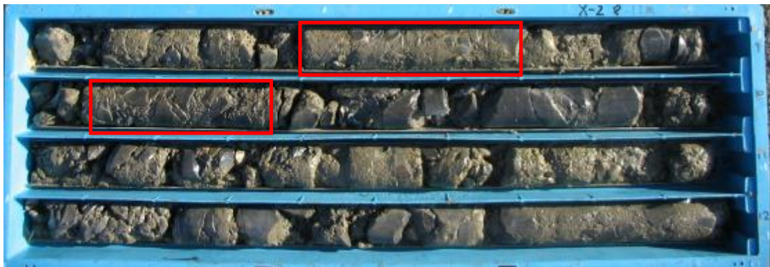
圖 3-9 鑽探岩心圖崩積土併構岩 X-1 14.45~14.7 m
