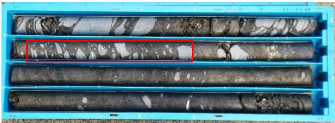
圖 3-15 鑽探岩心圖漸變帶併構岩 N-2 33.05~33.6 m
