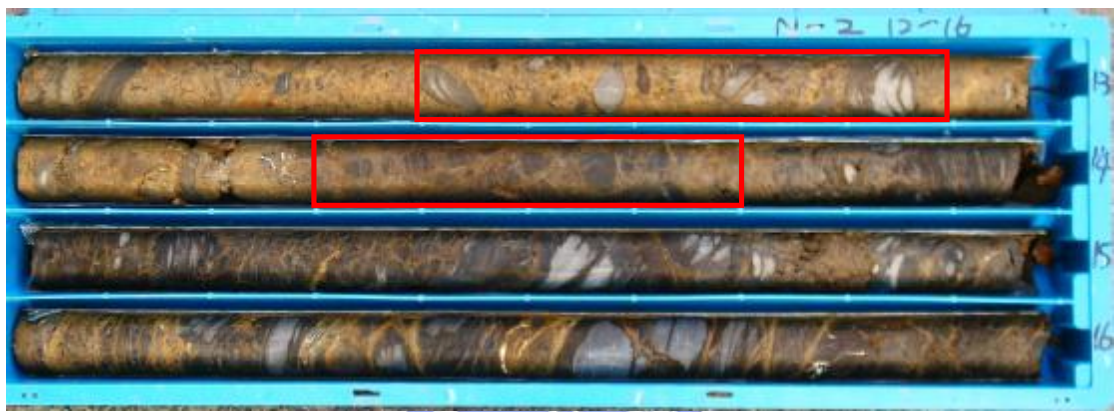
圖 3-6 鑽探岩心圖崩積土併構岩 N-1 4.35~4.6 m
