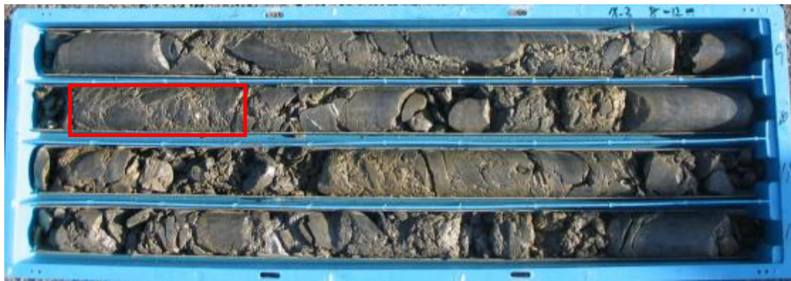
圖 3-13 鑽探岩心圖崩積土併構岩 X-3 9.05~9.3 m
