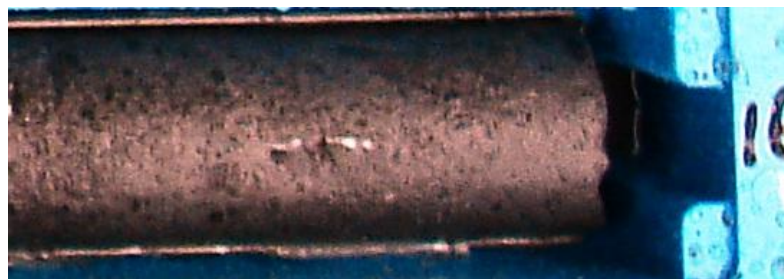
圖 2-4 第一類：灰色黏土夾灰色板岩顆粒 (賴忠良，2006)
