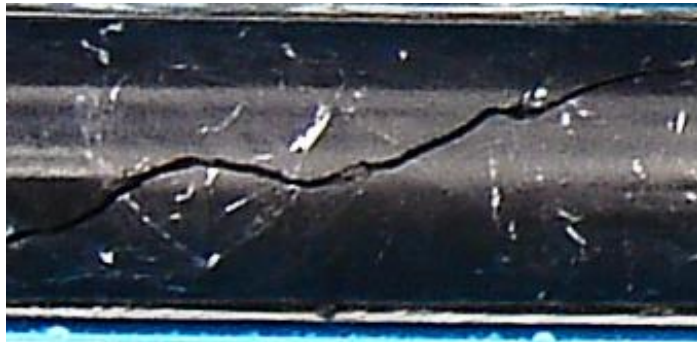
圖 2-7 第四類：灰色板岩內含有節理(節理厚度可忽略) (賴忠良，2006)
