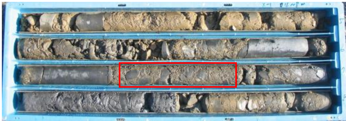
圖 3-7 鑽探岩心圖崩積土併構岩 N-2 12.4~12.9 m 及 N-2 13.3~13.7 m
