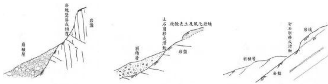
圖 2-1(a)岩塊堆積崩積層(b)土石混合堆積崩積層(c)岩層滑動崩積層(董家鈞、楊賢德，2001)
