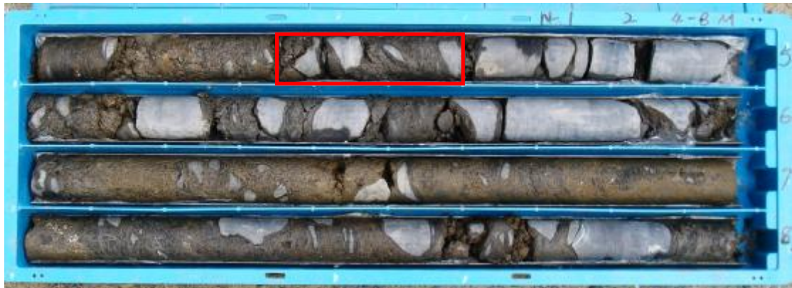
圖 3-6 鑽探岩心圖崩積土併構岩 N-1 4.35~4.6 m
