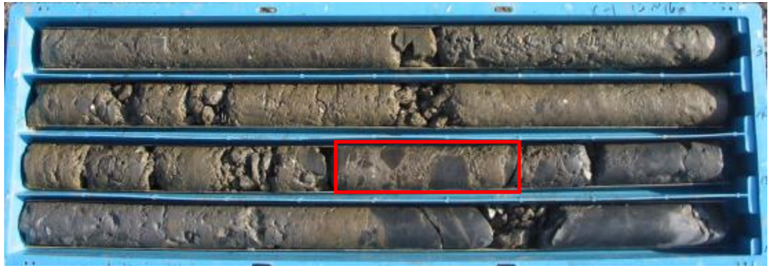
圖 3-9 鑽探岩心圖崩積土併構岩 X-1 14.45~14.7 m
