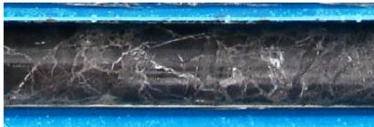
圖 2-5 第二類：破碎板岩岩體 (賴忠良，2006)
