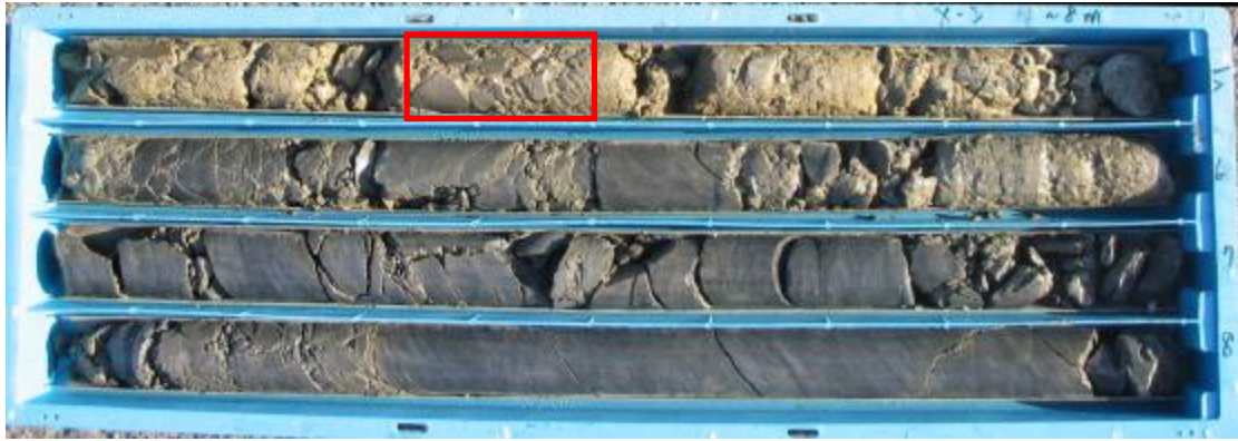
圖 3-12 鑽探岩心圖崩積土併構岩 X-3 4.35~4.5 m
