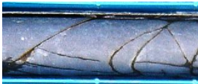
圖 2-6 第三類：灰色板岩內含有節理(節理厚度不可忽略) (賴忠良，2006)
