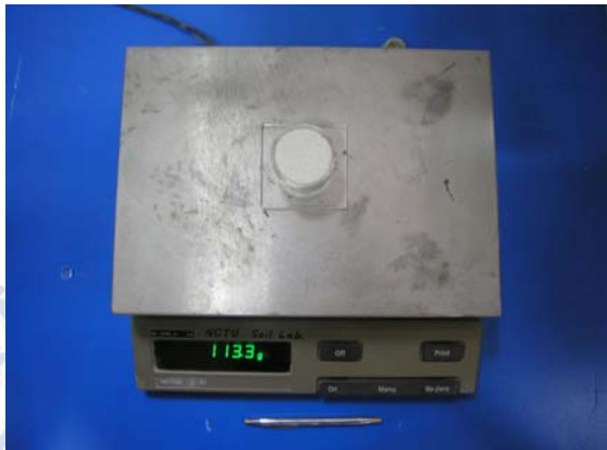
(d) Measurement of cup and soil mass
