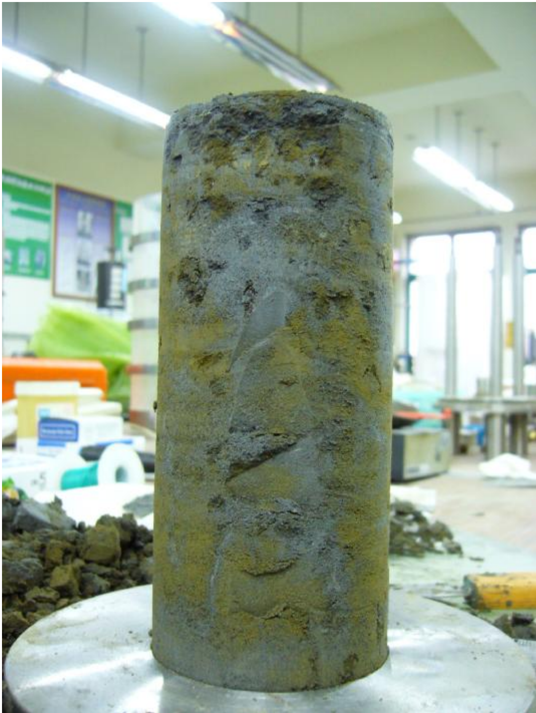
圖 5.4 員林 Laval 試體 FC = 43%
