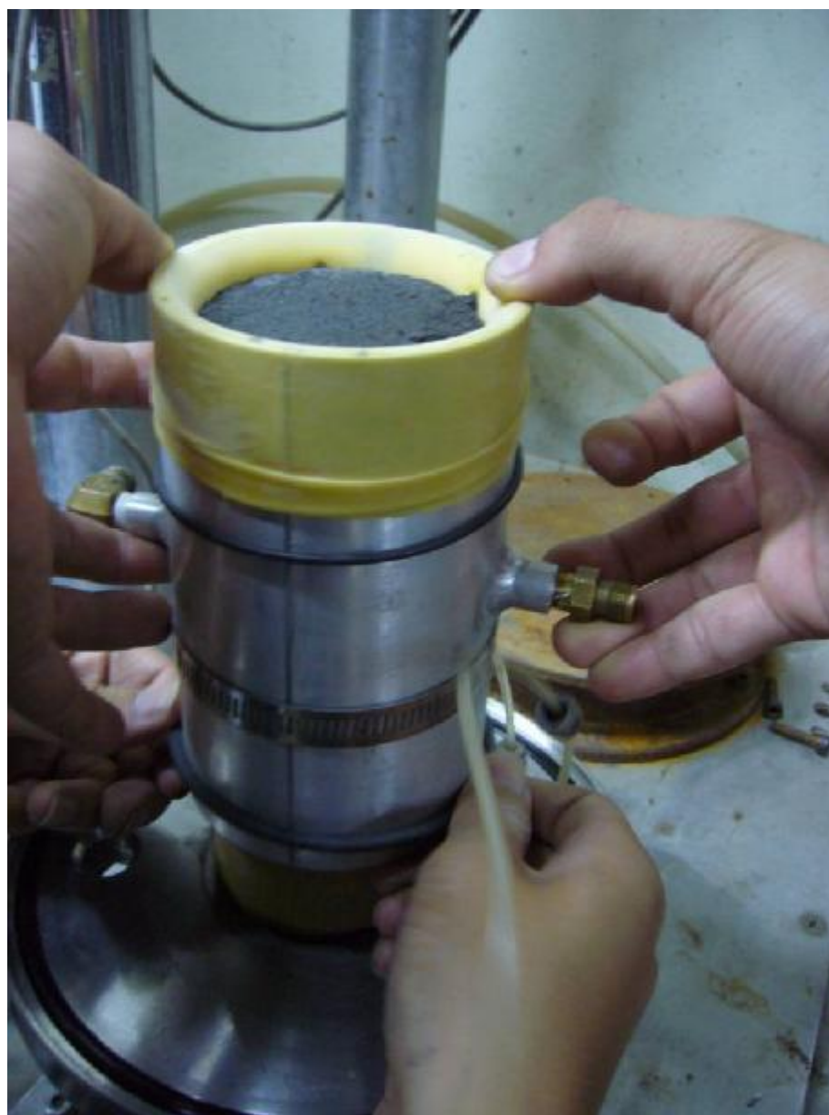
圖 3.18 使用 sample holder 保護試體
