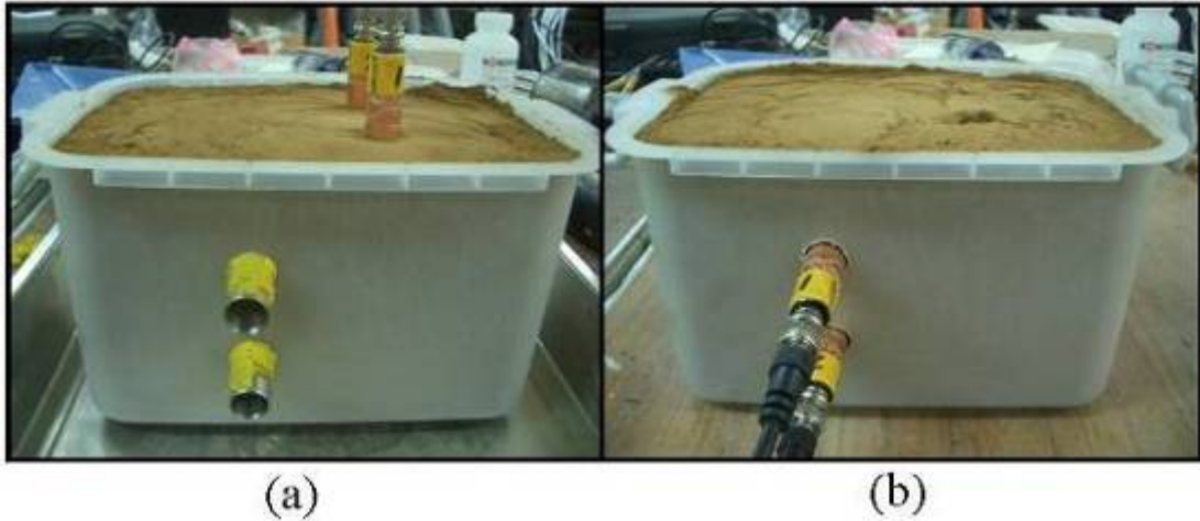
圖 3-6 TDR 率定電阻率與體積含水量 (a) 垂直量測 (b) 水平量測
