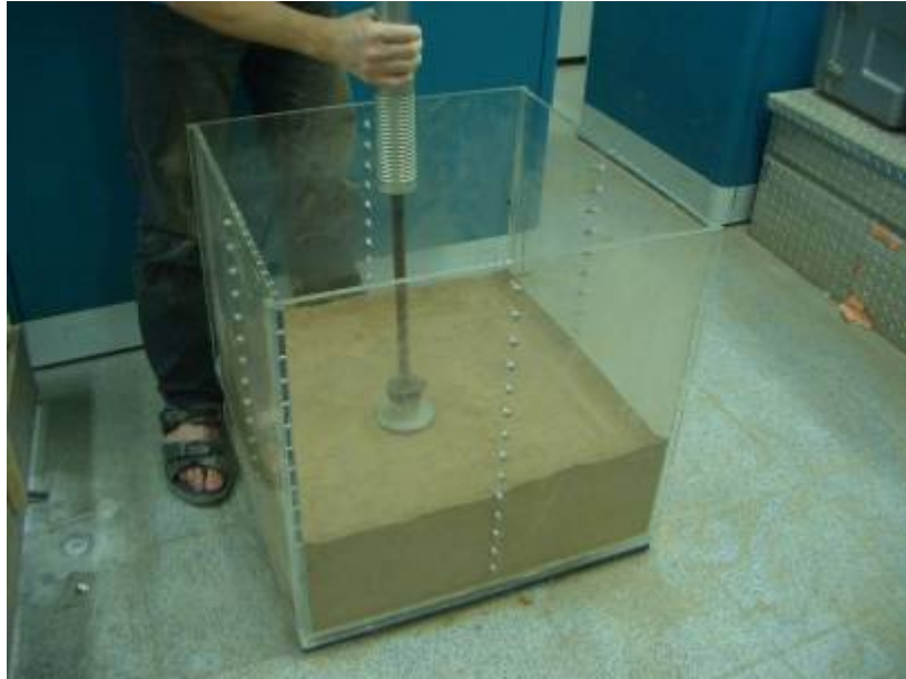
圖 3-8 大型夯錘將土樣分層夯入砂箱
