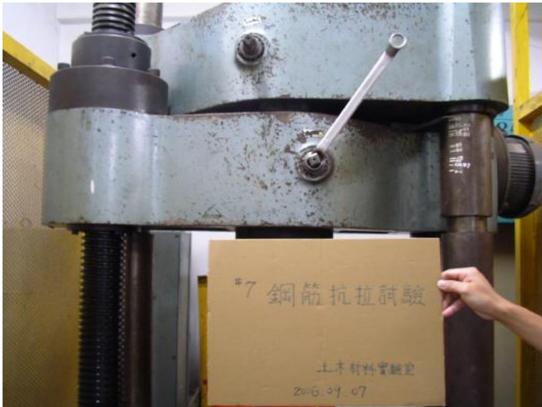
圖 3.19 萬能材料試驗機(100 噸)
