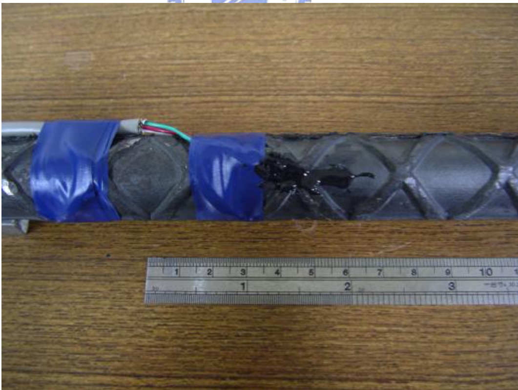
圖 3.18 使用 AX-019 防水膠保護應變片
