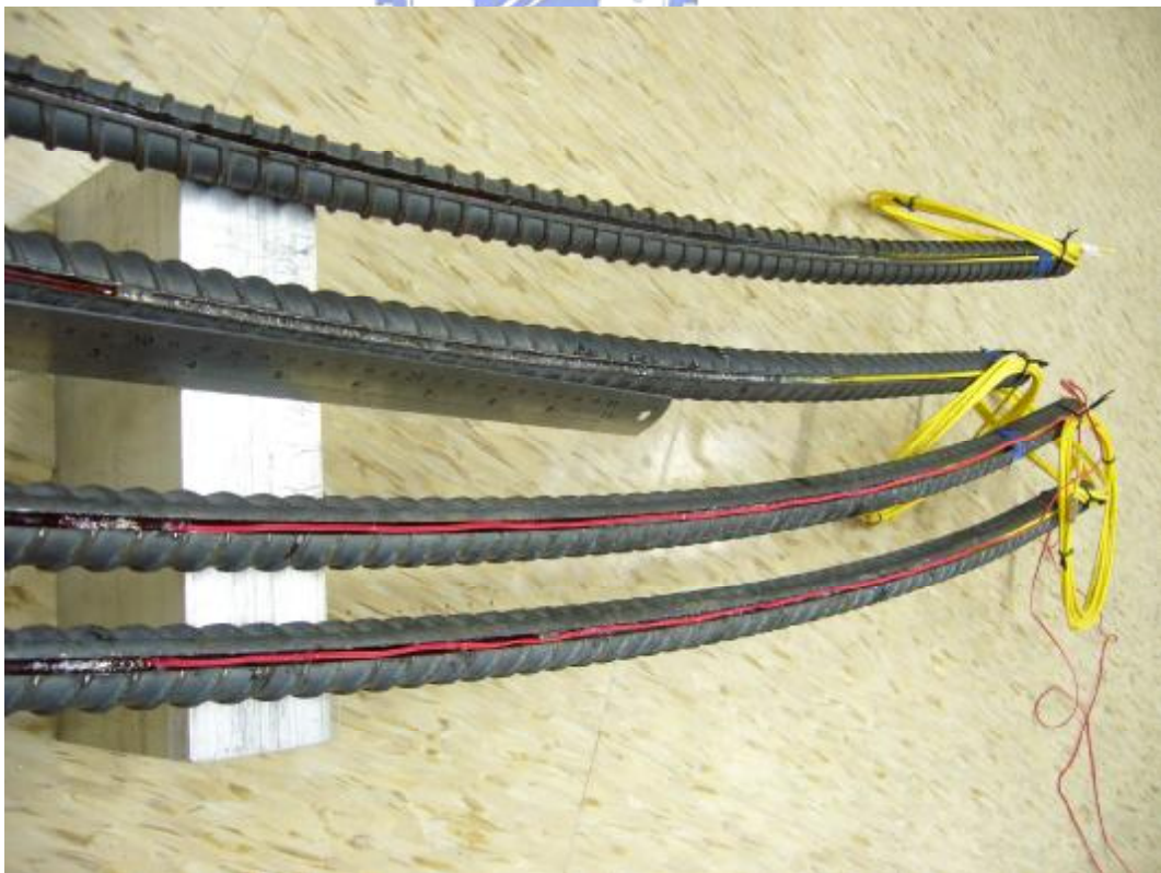
圖 3.28 鋼筋尾端熔接光纖延長段
