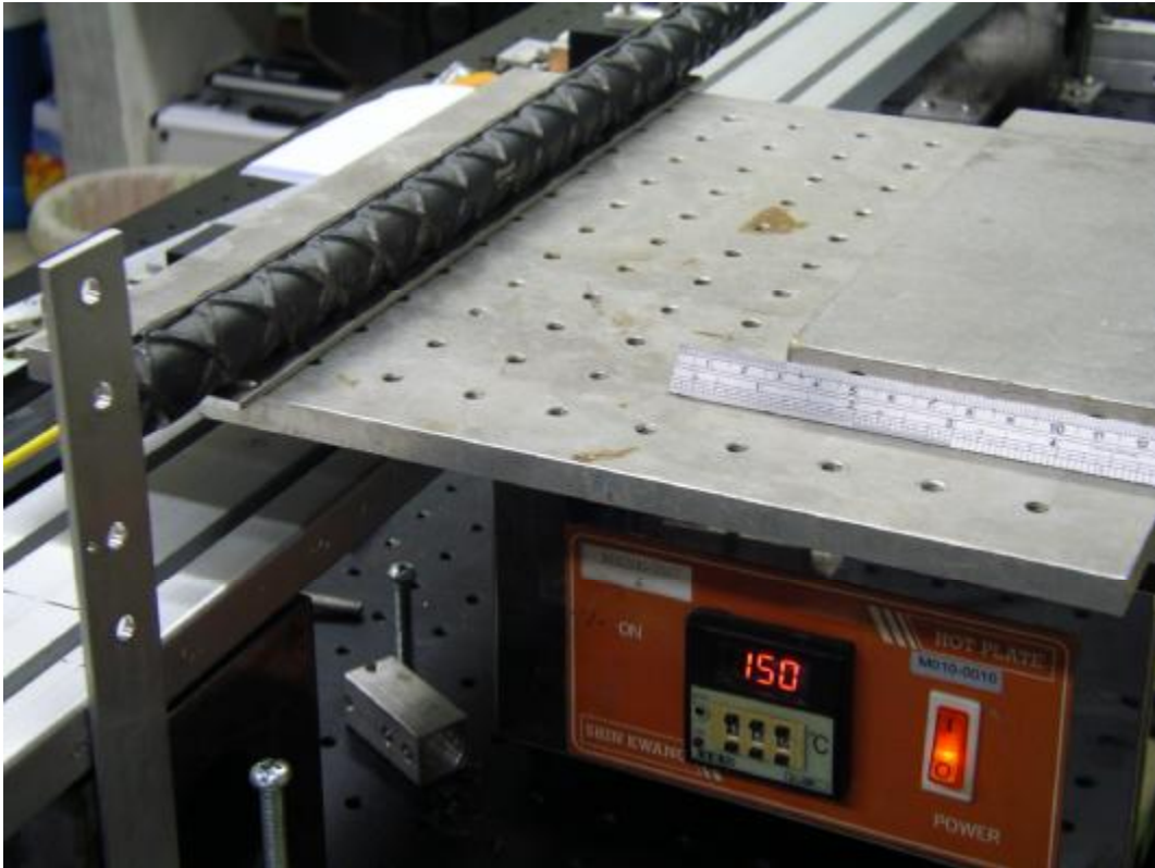
圖 3.15 50cm 鋼筋預拉架設圖
