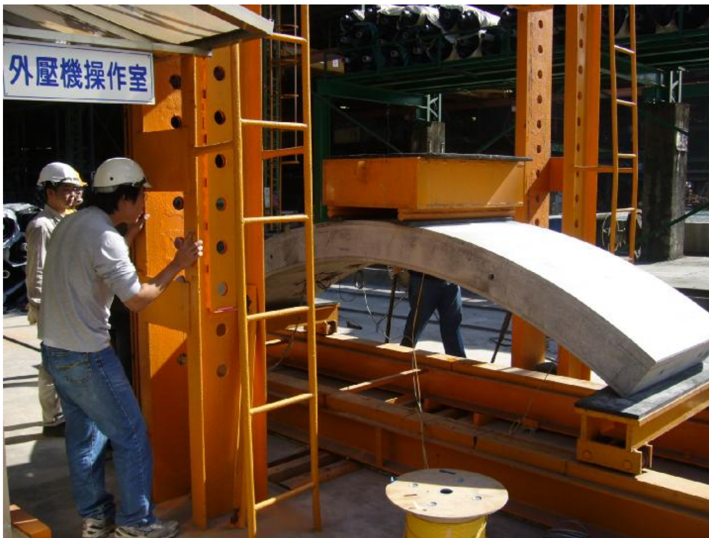
圖 4.16 環片抗彎試驗架設圖
