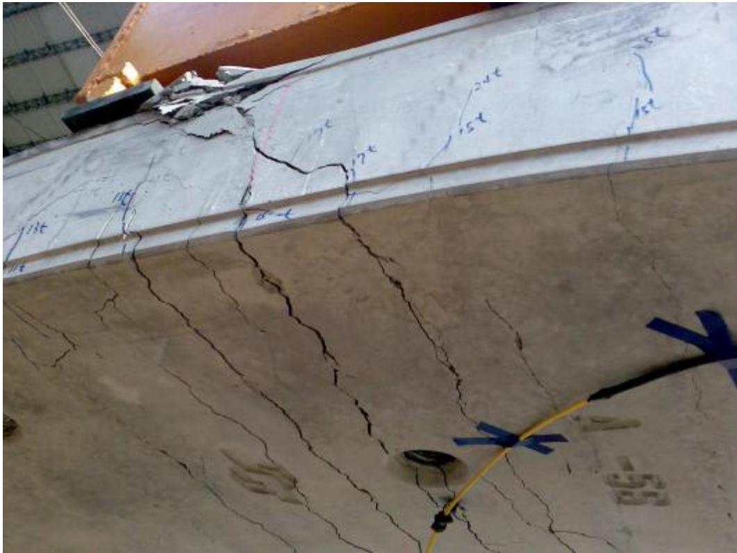
圖 4.20 環片加載過程記錄裂紋生成之載重
