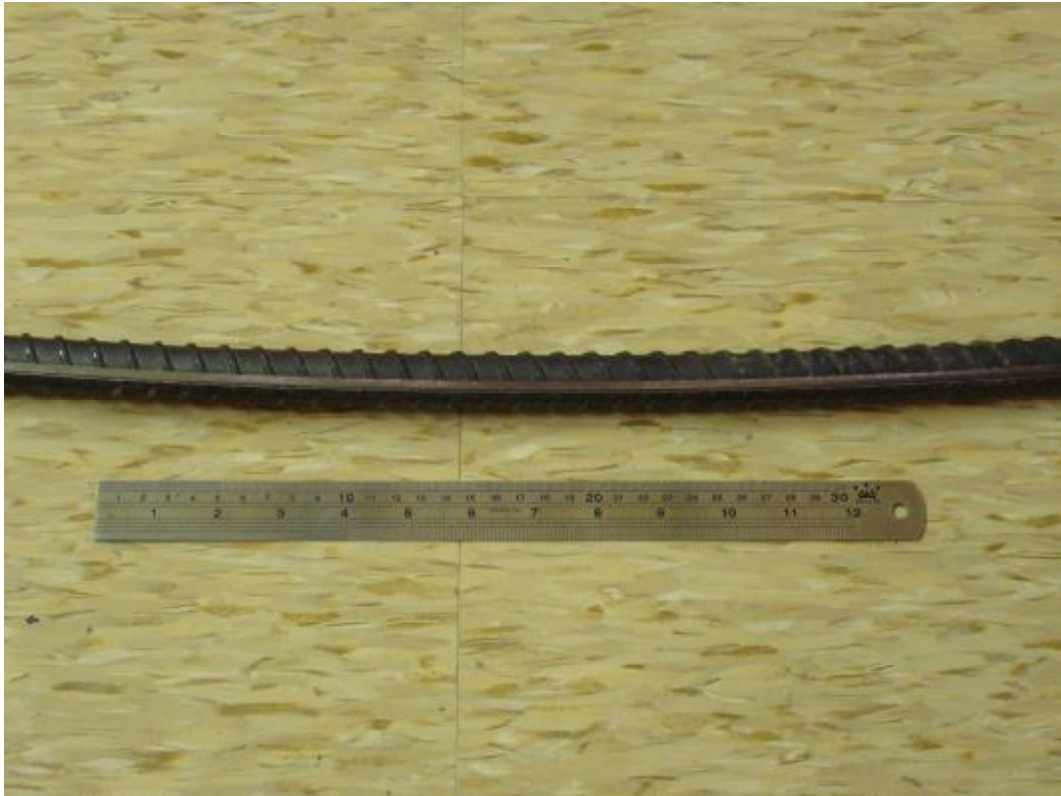
圖 3.27 臺北捷運 CR580A 區段標工程用之七號鋼筋，中間銑一溝槽
