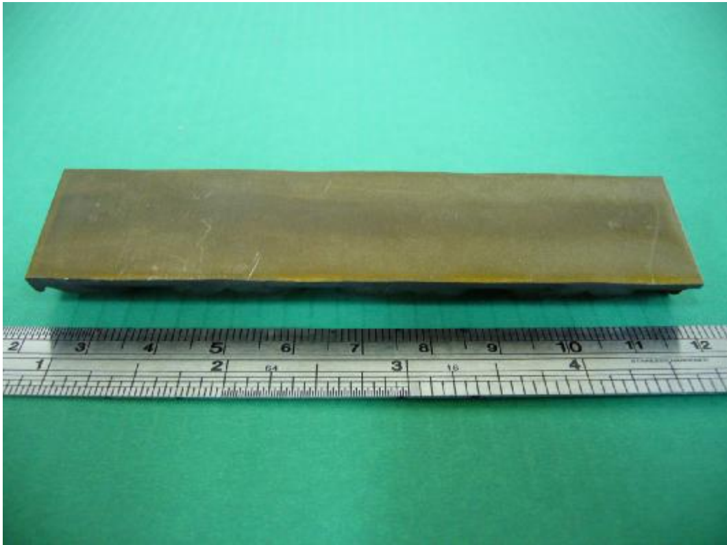
圖 3.7 長度 10cm 之七號鋼筋沿軸向切半
