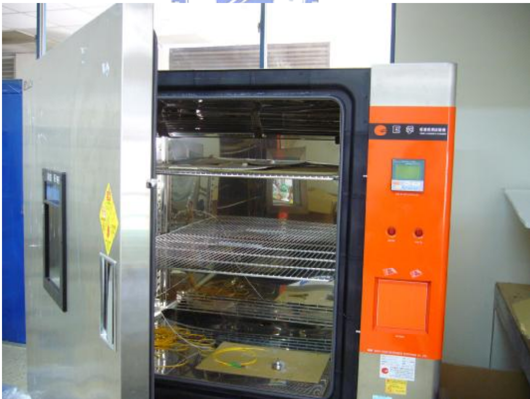
圖 3.6 可程式恆溫恆濕試驗機
