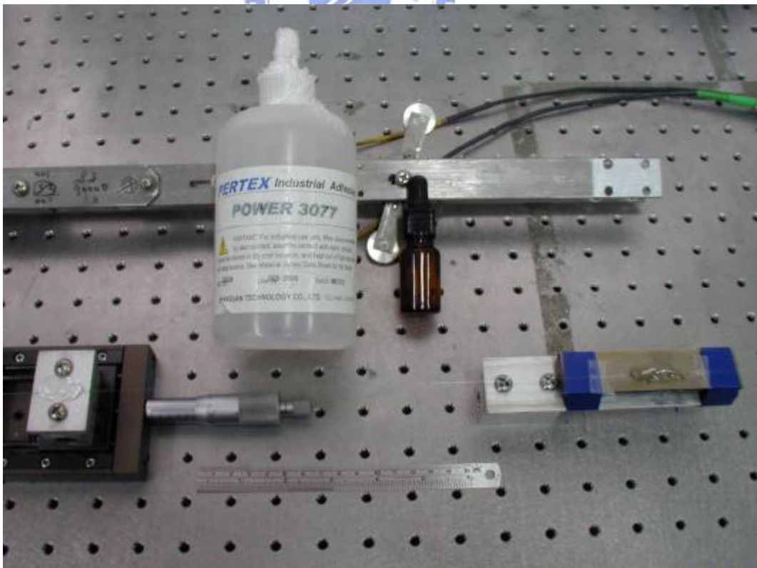
圖 3.8 接著劑測試之儀器架設圖
