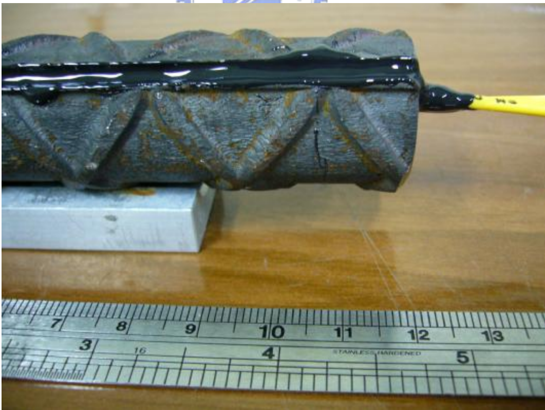
圖 3.25 使用 AX-019 防水膠填滿鋼筋溝槽
