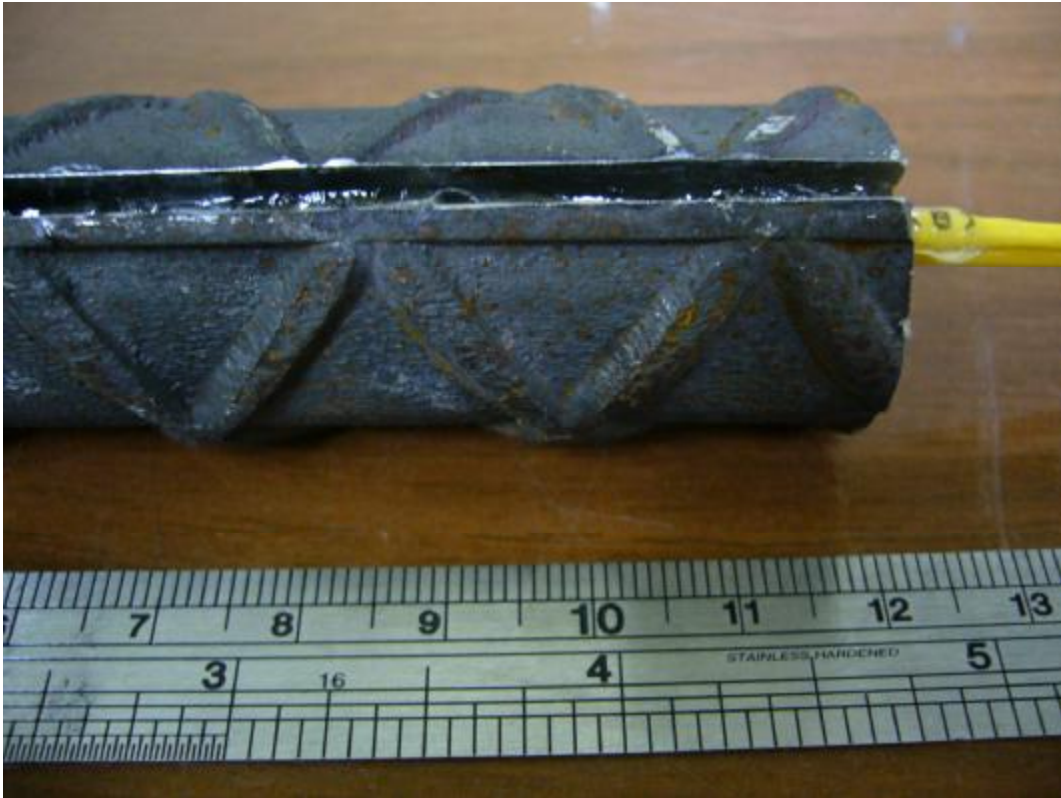
圖 3.24 以 POWER3077 固定光纖光柵溫度感測器
