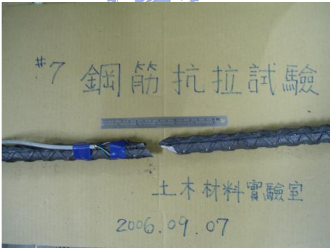
圖 3.20 鋼筋拉伸試驗結果
