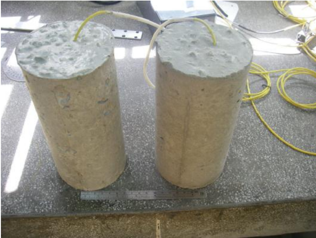
圖 3.12 七號鋼筋(10cm)灌鑄成混凝土圓柱
