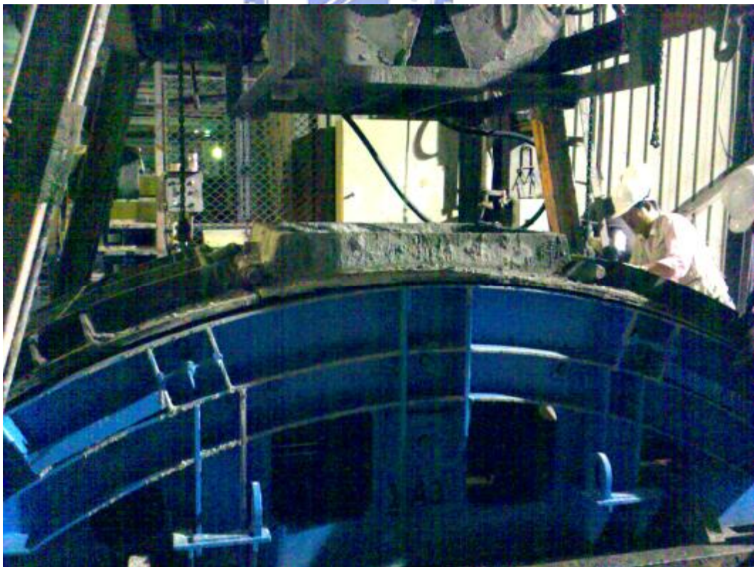
圖 4.7 鋼模蓋上頂蓋並以夾具固定四周
