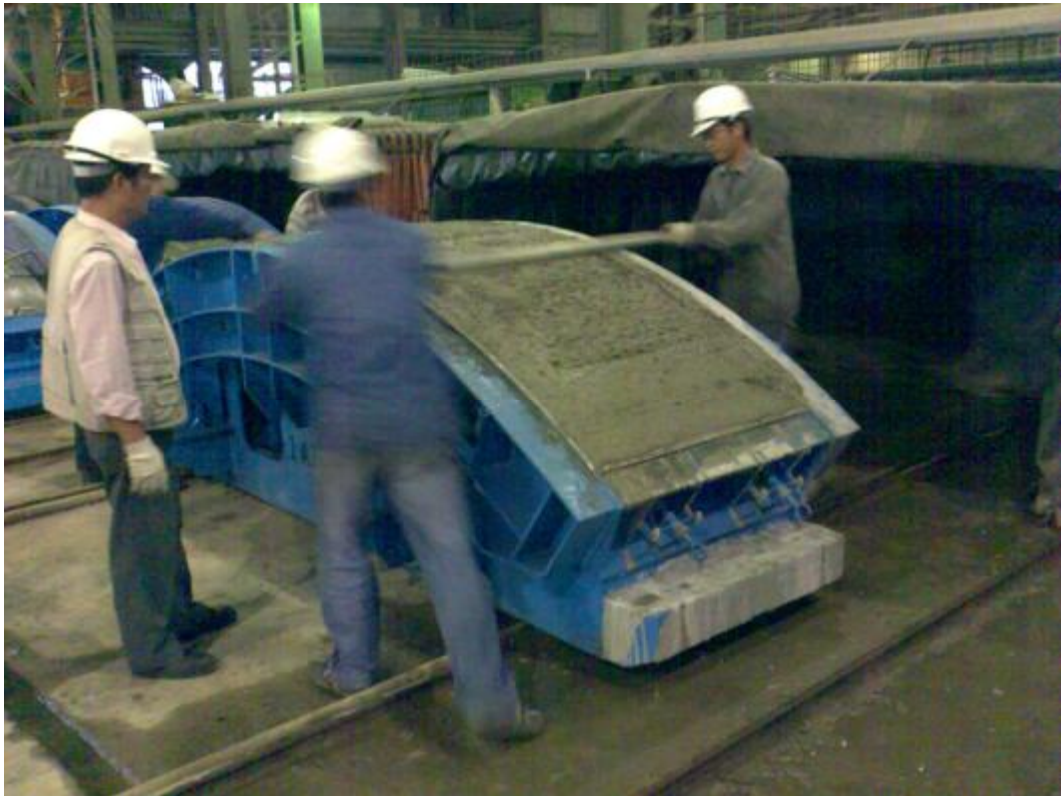
圖 4.8 以人工方式抹平環片外側表面
