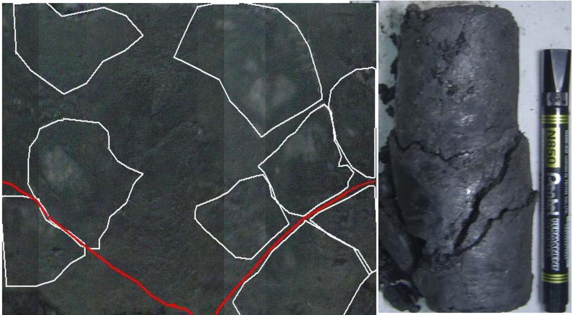
圖 5.20 破壞曲線與岩塊分佈圖(AH-1 37.80 ~ 37.95m)
