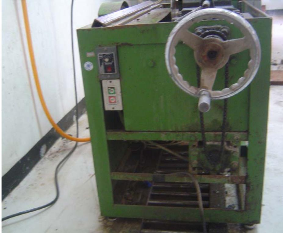
圖 4.8 岩心切割機控制旋鈕介面圖
