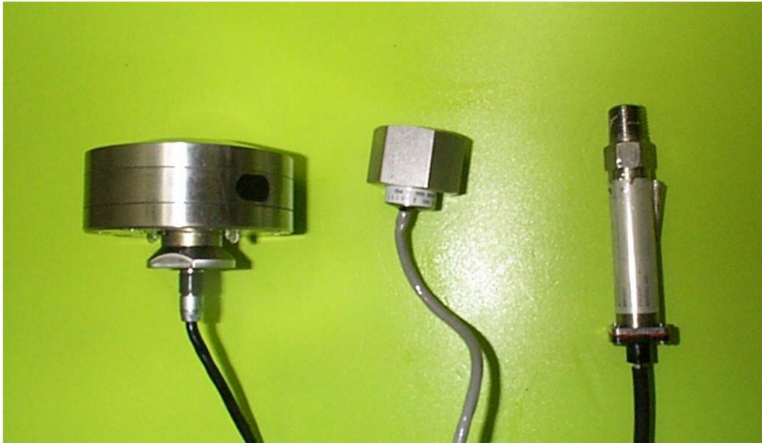
圖 3.7 內置式荷重計、壓力轉換器(摘錄自林智惠 2003)
