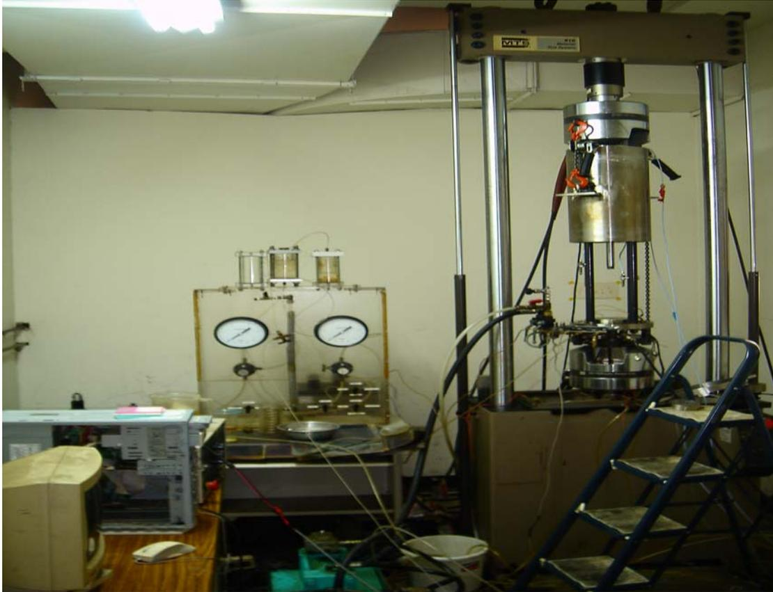
圖 3.2 軟岩三軸試驗系統全景
