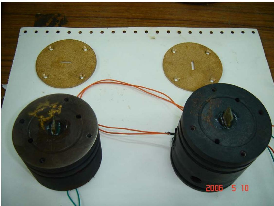
圖 3.14 上下蓋加裝剪力波元件完成圖
