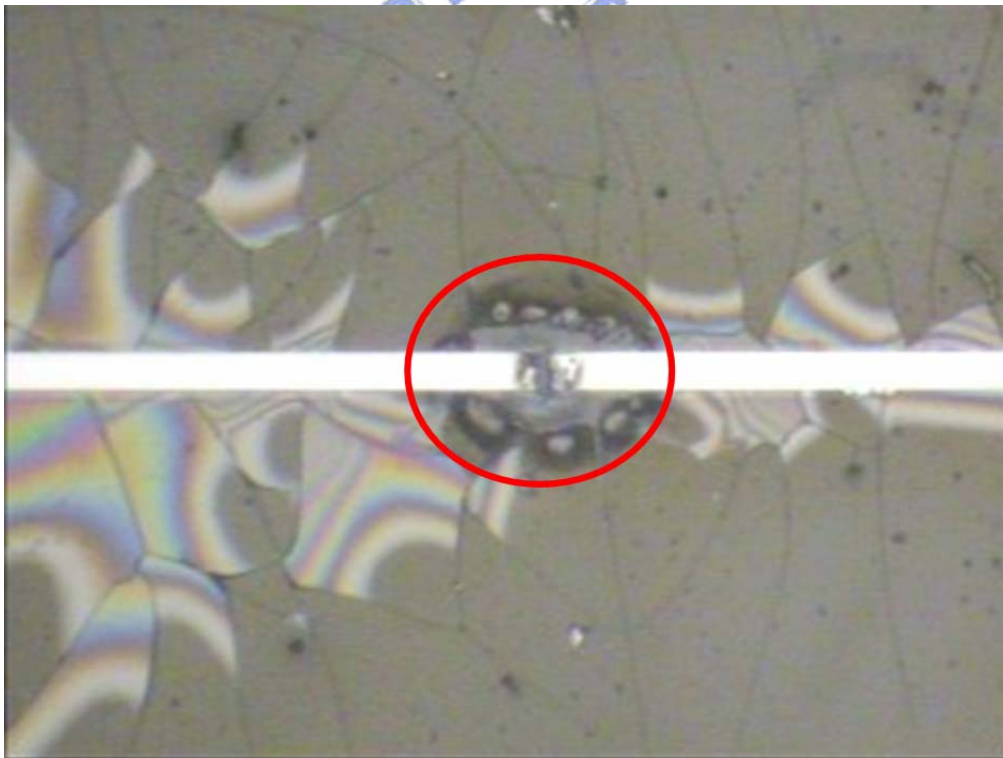
圖3-3 (b) COG 玻璃端鋁導線破壞位置
