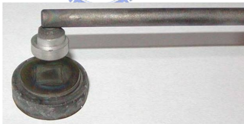
圖 4-1 圓穹型上電極以及圓形試片基座。
