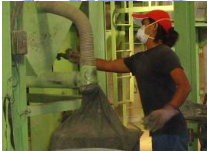
圖4.8 (a) 工作人員以鐵鎚敲擊旋轉閥出料口與鉛粉桶
