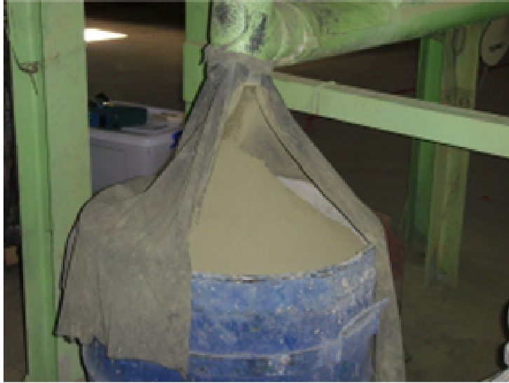
圖4.8 (b) 更換鉛粉桶前鉛粉滿桶狀況
