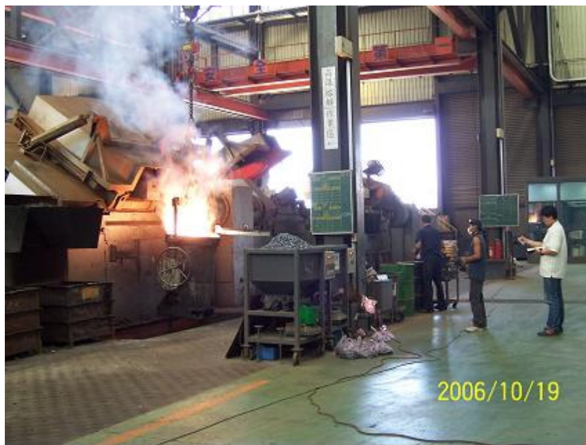
圖4.24 (b) 鐵水傾倒時所逸散的煙
