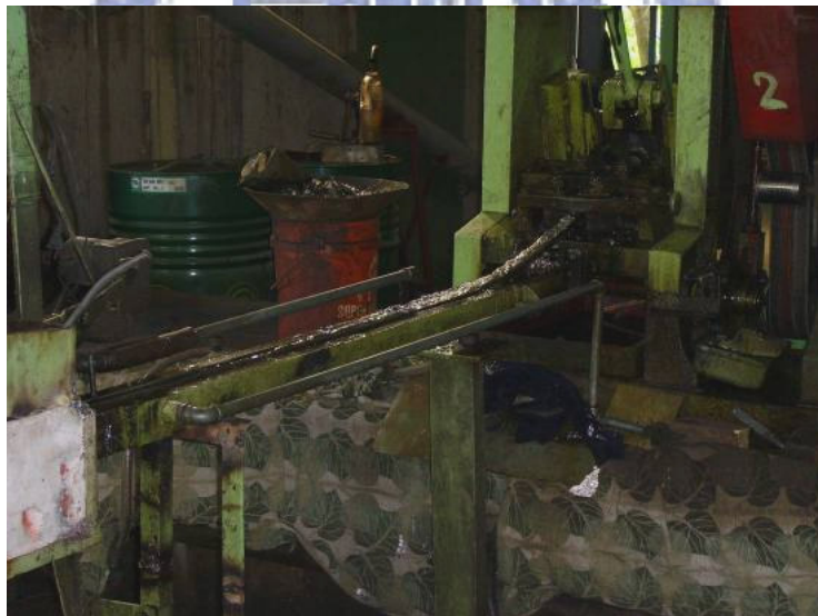
圖4.9(a) 鉛粉塊通過熔鉛爐後經冷卻槽運送至鉛棒切斷機
