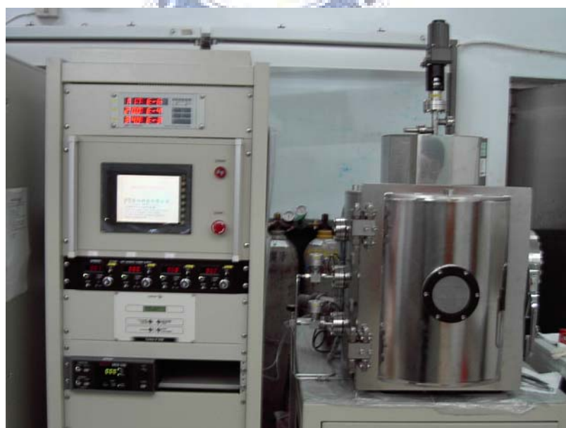
圖2-1 反應性直流磁控濺鍍機。
