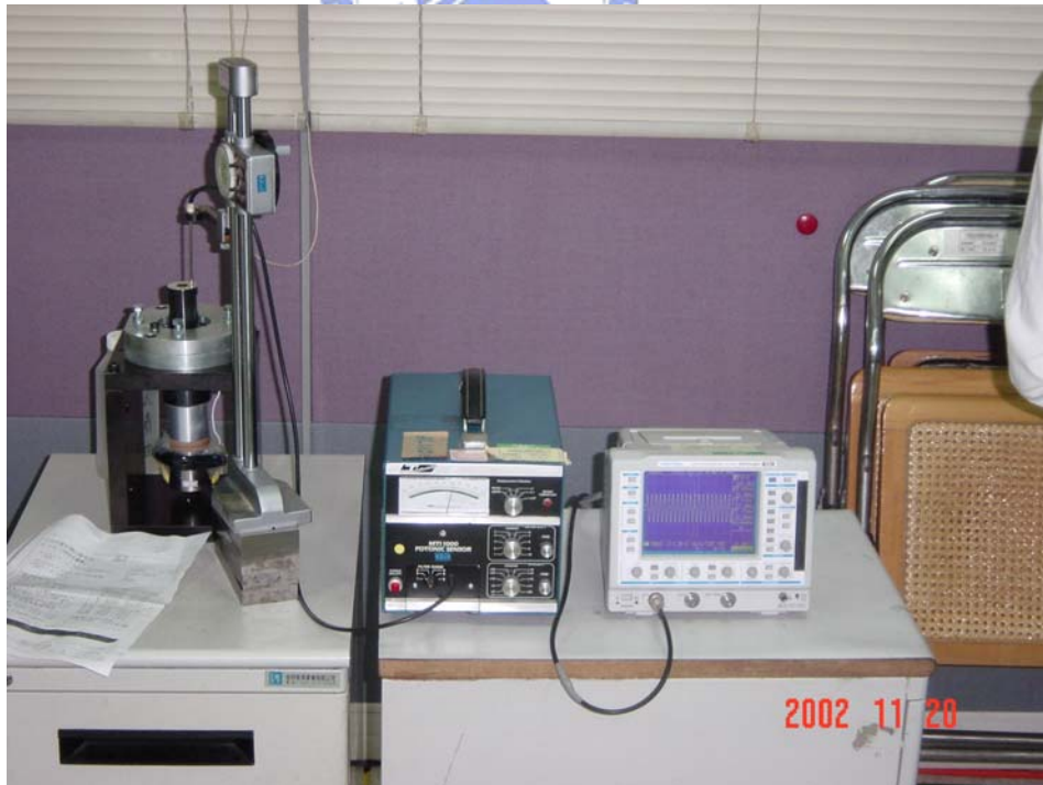
圖 3-11 超音波振動頻率與振幅之量測
