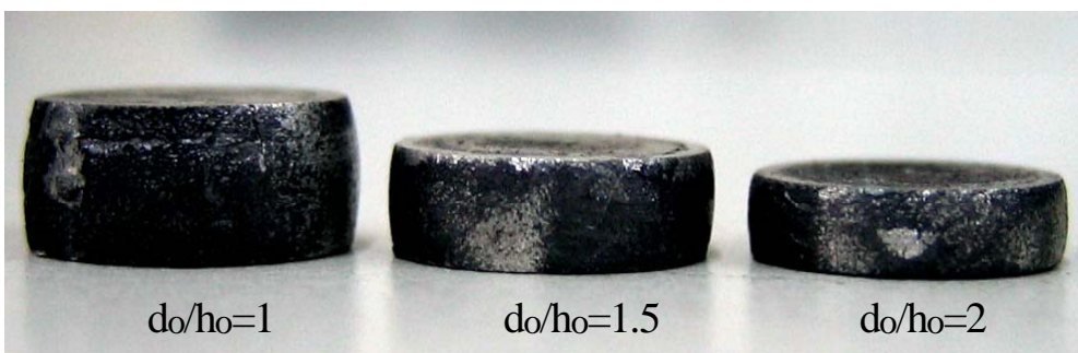
(c) HCC 於 150^{\circ}\text{C} ，壓縮負荷 15000 N 之實驗結果試片實體圖
