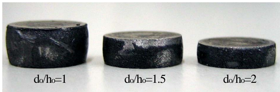
(b) AUC 於 25^{\circ}\text{C} ，壓縮負荷 15000 N 之實驗結果試片實體圖
