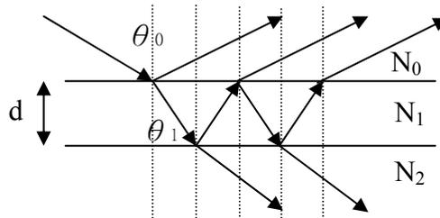
圖 2-6：多次反射型示意圖
