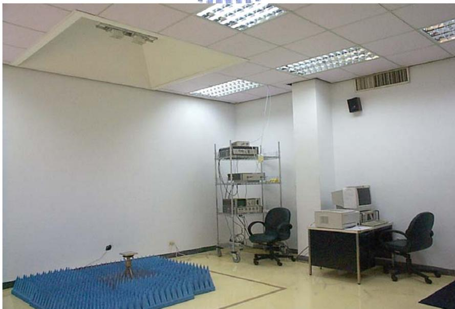
圖 3.3 微波反射率量測系統架設圖
