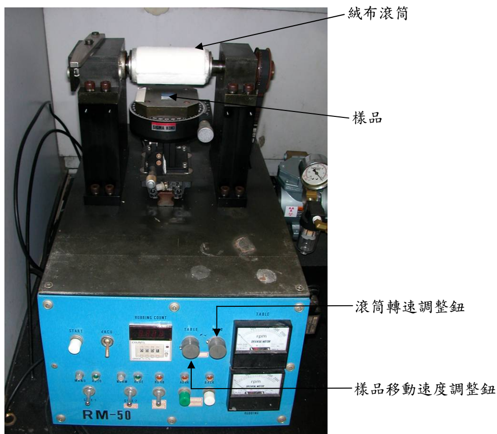
圖3-2 定向刷膜設備裝置圖。
