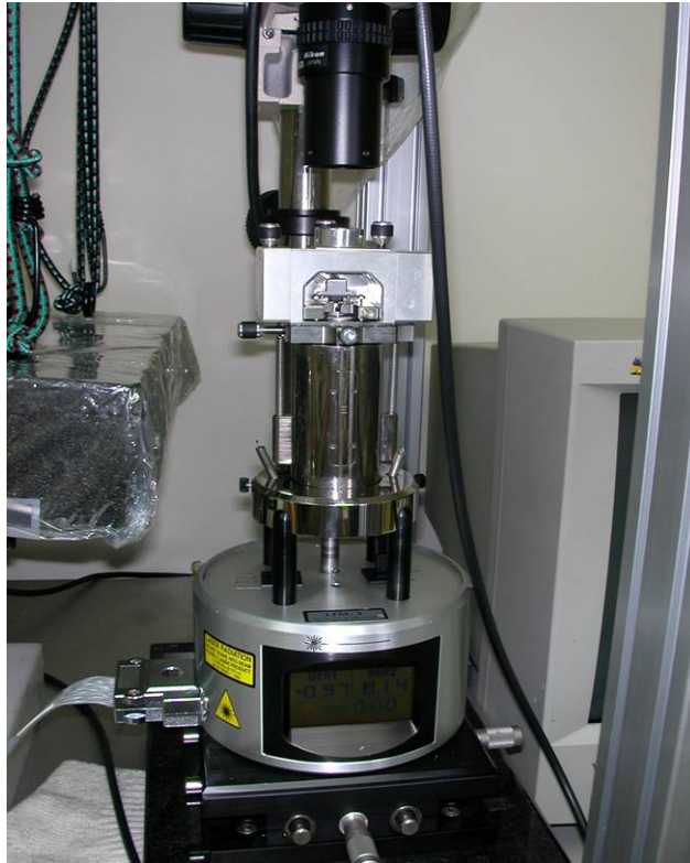
圖3-13 AFM儀器裝置圖。
