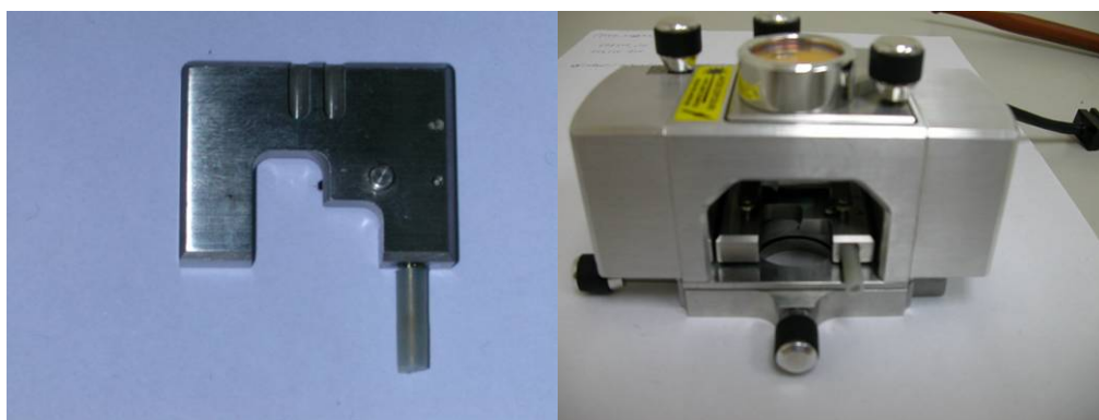
圖3-12 AFM探針放置圖。
