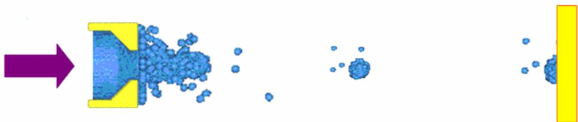
Fig. 1-1 噴流系統示意圖。藉由微奈米尺度的噴嘴系統製造出奈米液滴，是目前受到重視的高潛力加工製程系統之一。
