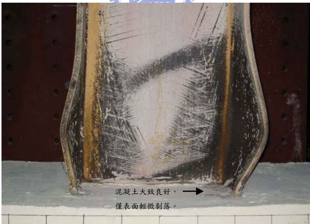
照片 4.8 試體 SRC3 鋼梁翼板邊緣情形：位移 11\Delta y 時( Story Drift Angle \theta_t = 5.25\% \text{ rad} , Beam Plastic Rotation \theta_{bp} = 4.28\% \text{ rad} )
