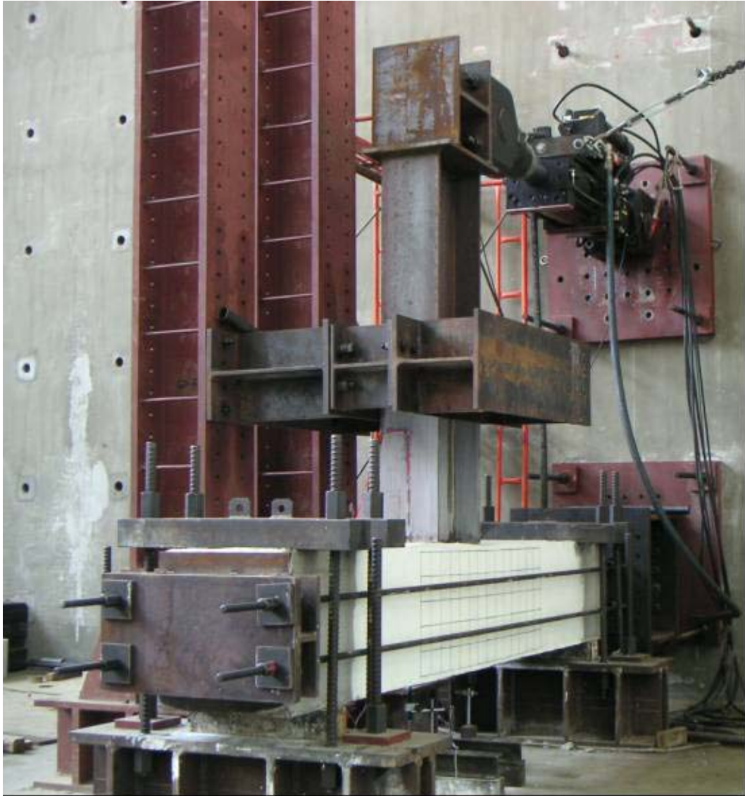
照片 3.3 SRC 梁柱接頭實驗架設全貌
