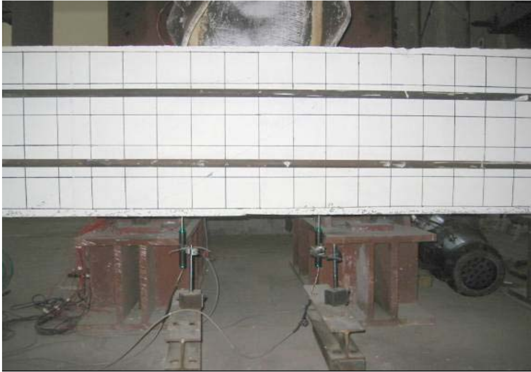
照片 3.5 SRC 柱下方設置線性變形位移感應計(LVDT)
