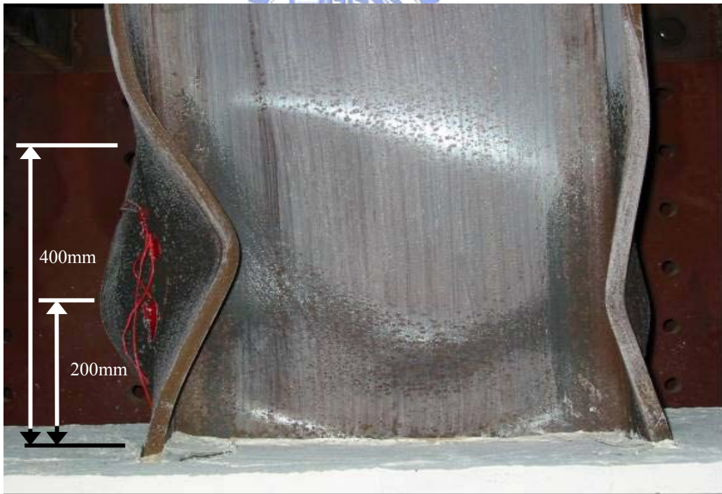
(d) 位移 11\Delta y 時( Story Drift Angle \theta_t = 5.23\% \text{ rad} , Beam Plastic Rotation \theta_{bp} = 3.99\% \text{ rad} )
