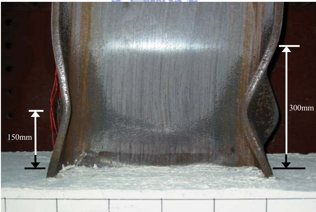
(d) 位移 11\Delta y 時( Story Drift Angle \theta_t = 5.24\% \text{ rad} , Beam Plastic Rotation \theta_{bp} = 4.14\% \text{ rad} )
