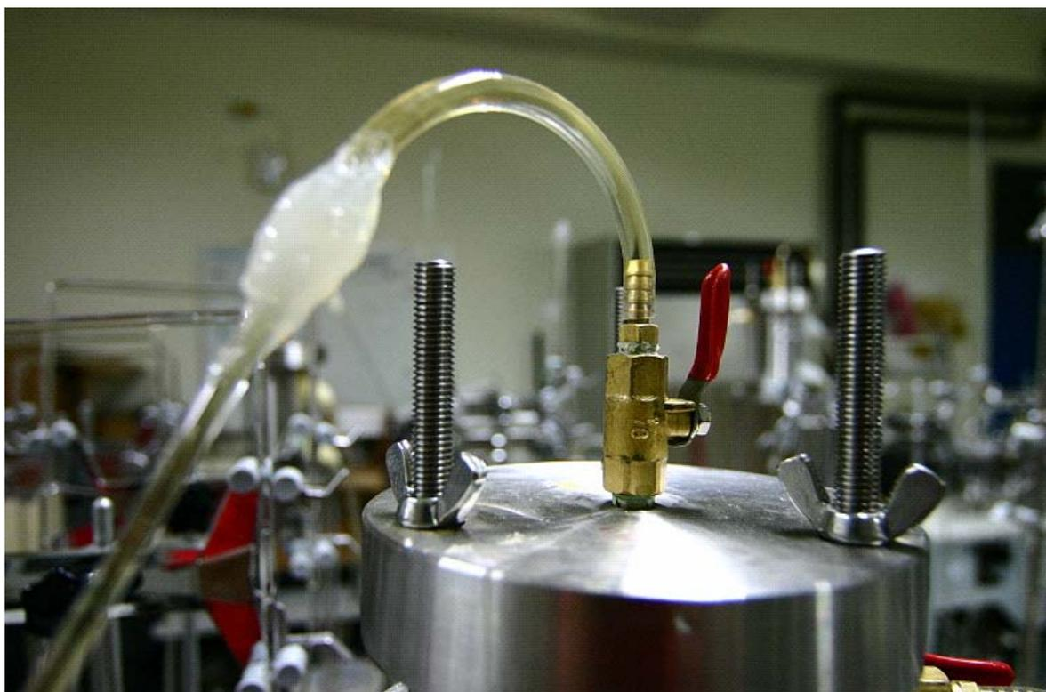
圖 3.12 滲透儀溢流口管線設置圖
