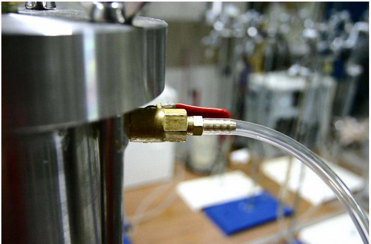
圖 3.14 側壁通氣孔示意圖
