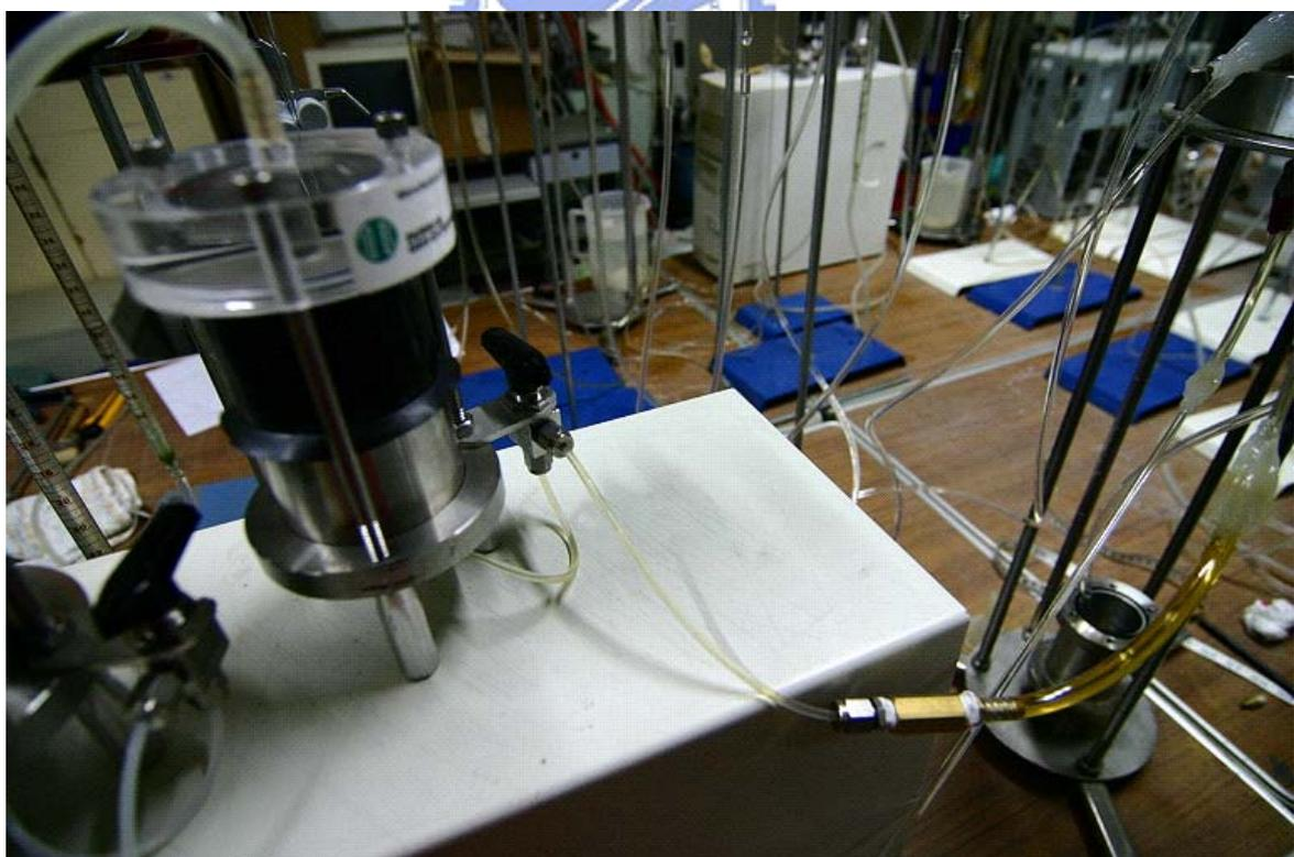
圖 3.13 滲透儀溢流口管線設置圖
