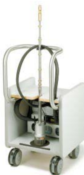
圖 3-1 PPMS (Physical properties Measurement System)基本構造，(a)電腦控制系統、杜瓦瓶 (b) ^3\text{He} 系統[4]
