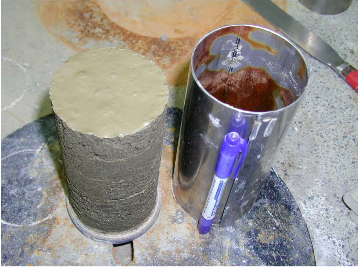
圖 4-7 水中沉降法製作高細料含量粉土質砂土之重模試體
