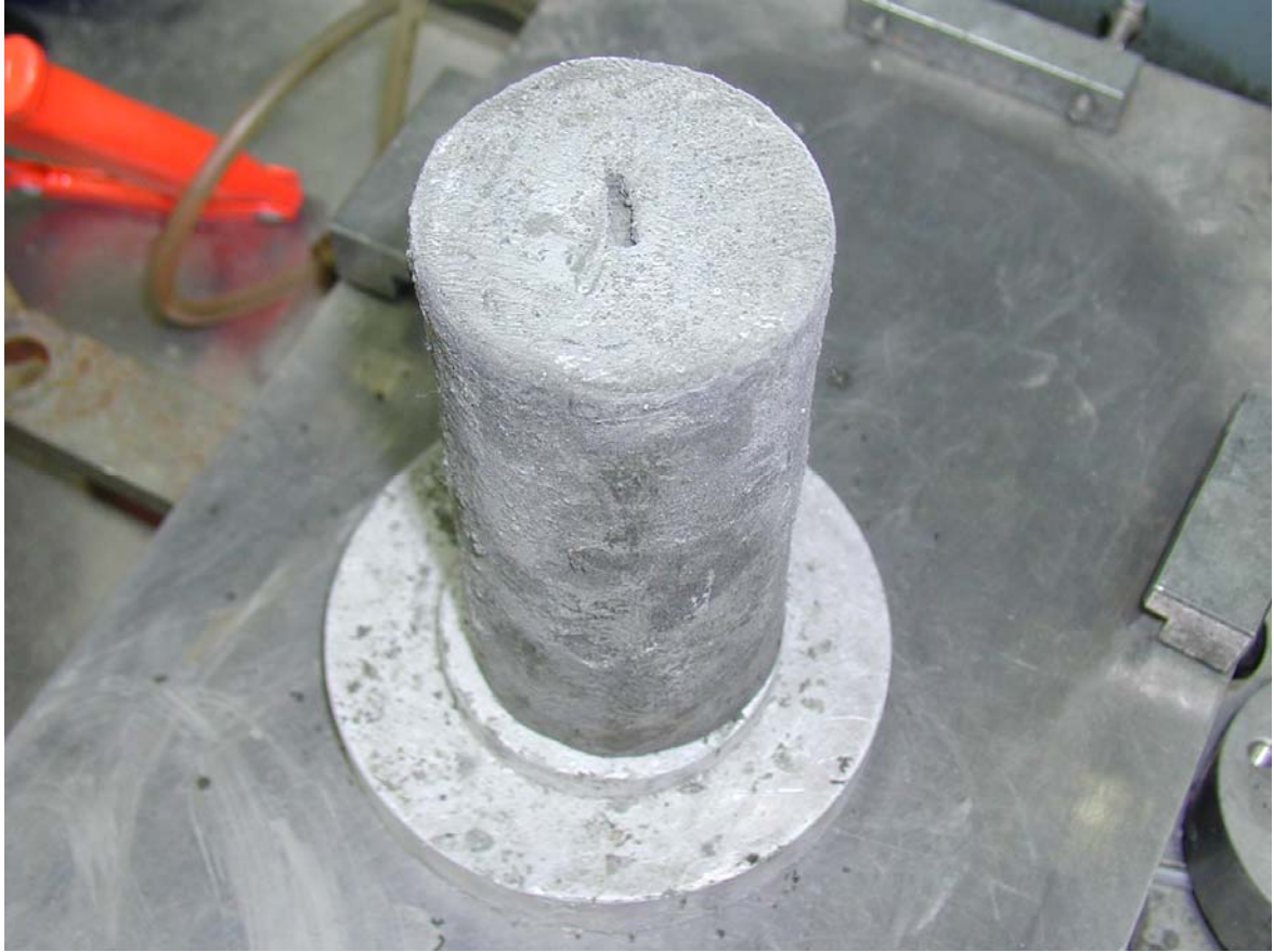
圖 4-3 裁切完成之冰凍試體
