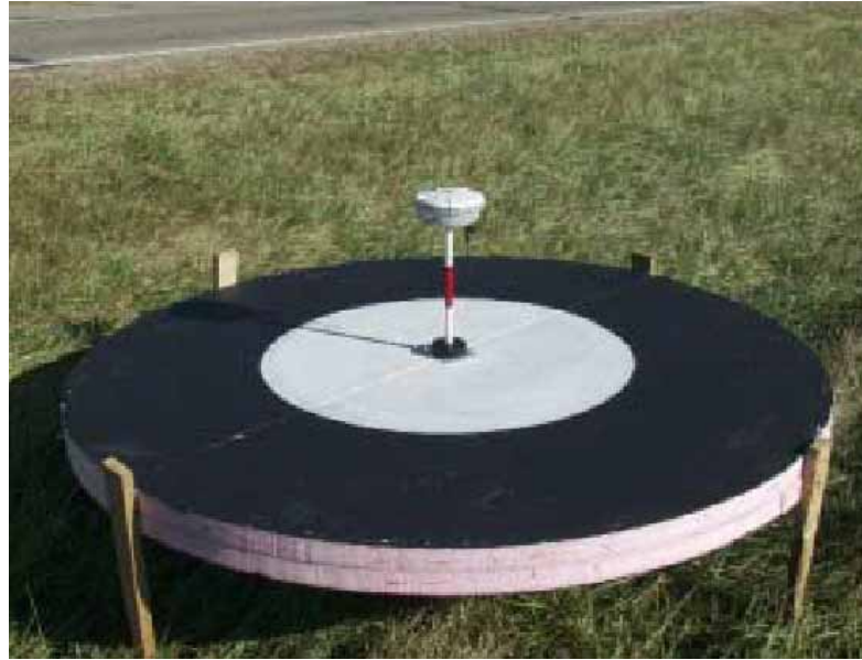
Figure 3.2: Ground control target for ALS (Csanyi, 2005)
