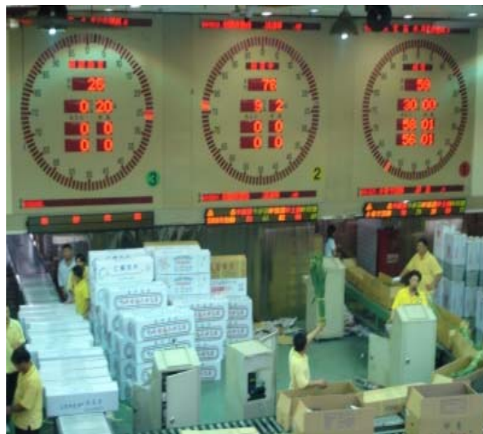
圖 3.2 彰化花市 LED 式拍賣鐘系統運作狀況
